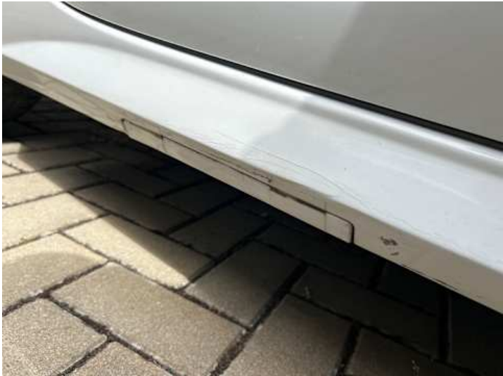
Schweller rechts (Kratzer, Verformung)
