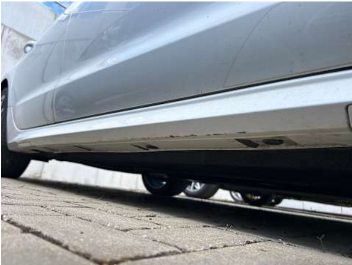
Schweller rechts (Kratzer, Verformung)
