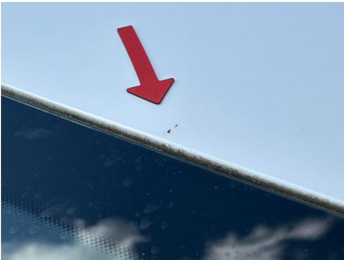
Dach (Steinschlag, Rost)
