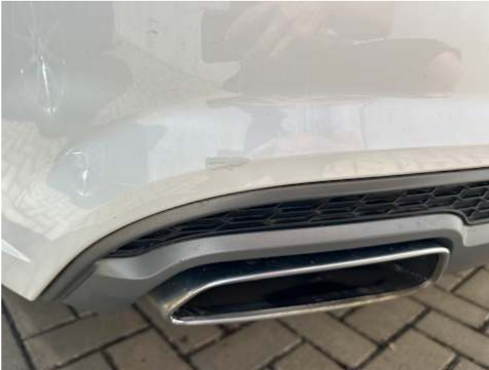
Stoßstange hinten (Kratzer, Unsachgemäß instand gesetzt)
