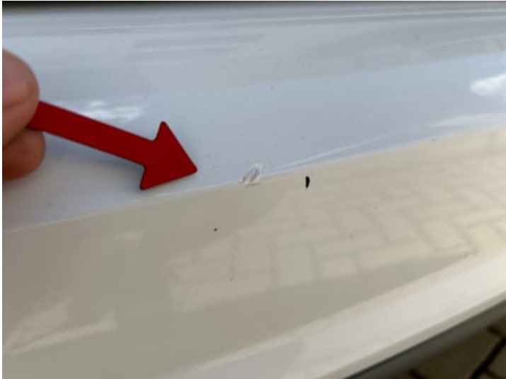
Stoßstange hinten (Kratzer, Unsachgemäß instand gesetzt)
