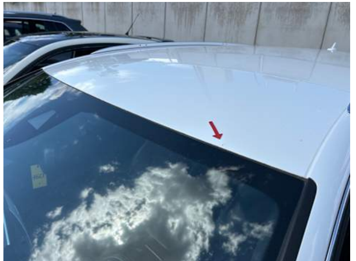
Dach (Steinschlag, Rost)
