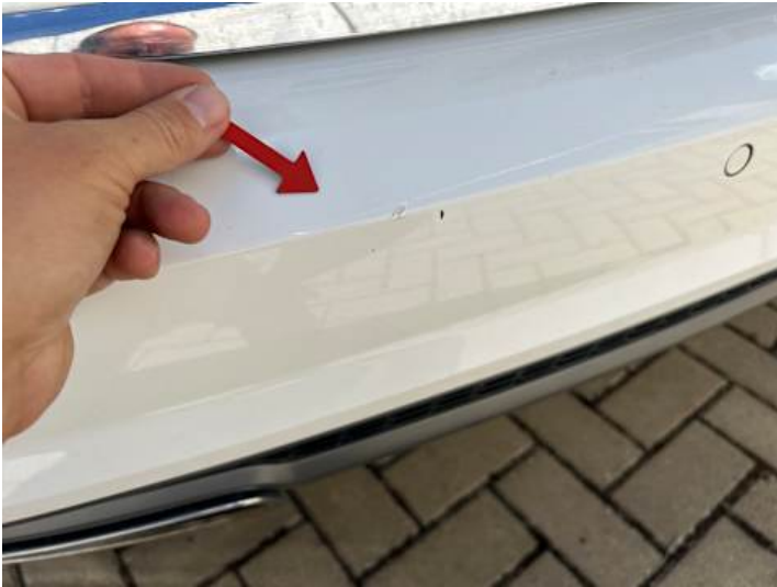
Stoßstange hinten (Kratzer, Unsachgemäß instand gesetzt)
