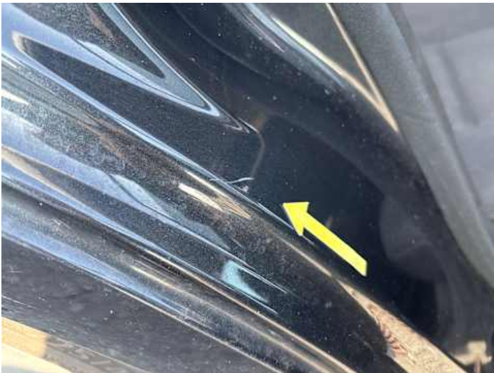
Türe hinten rechts (Kratzer)
