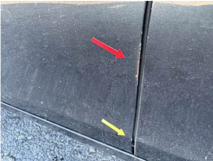
Fahrrertür (Lackschaden, Rost)
