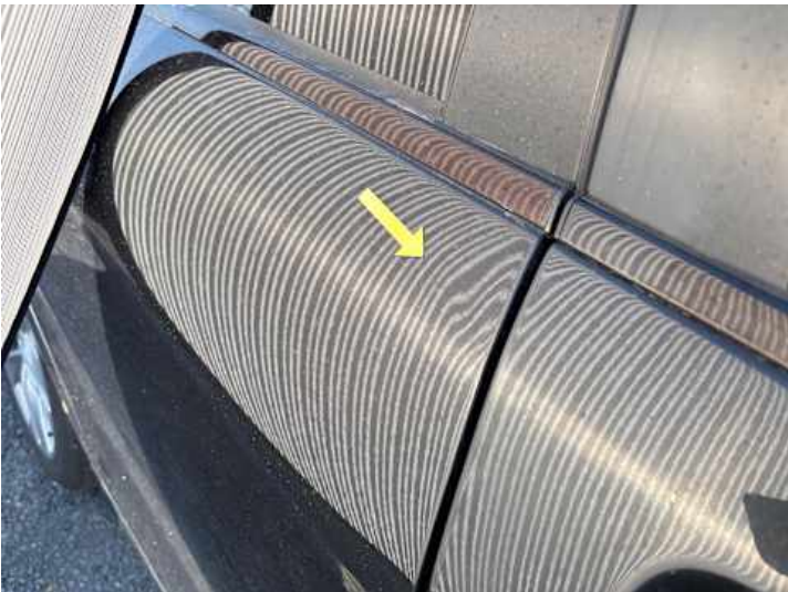
Türe hinten rechts (Delle)
