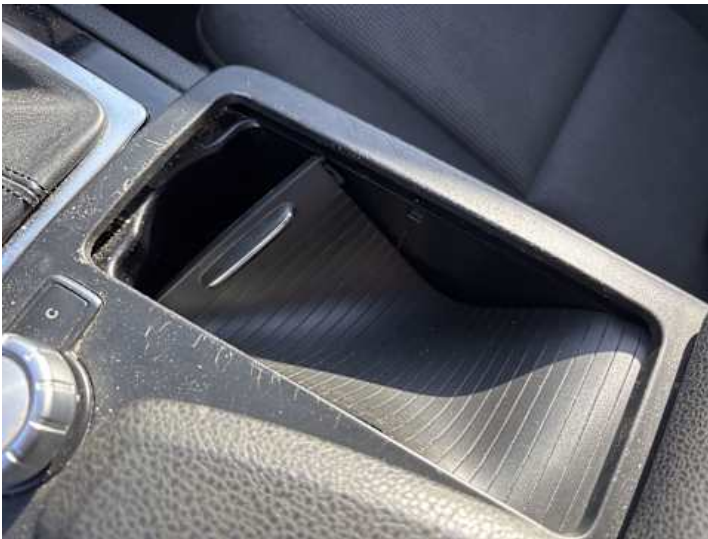
Innenraum (Riss/Bruch, Ohne Funktion)
