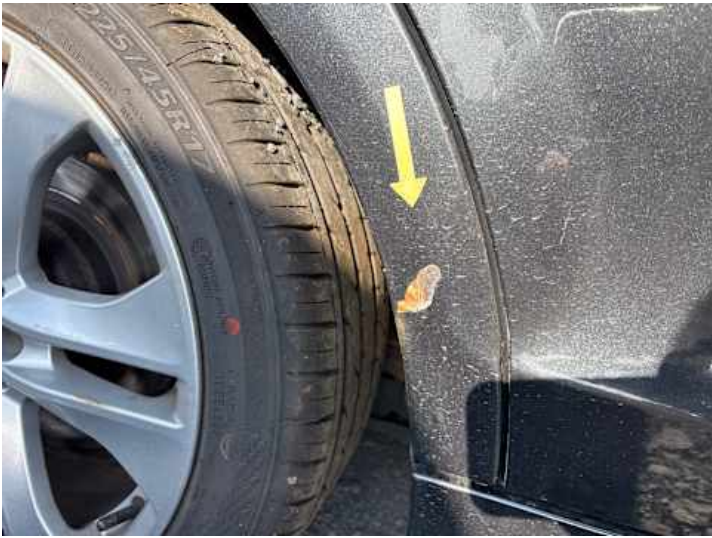
Seitenteil hinten rechts (Lackschaden, Rost)
