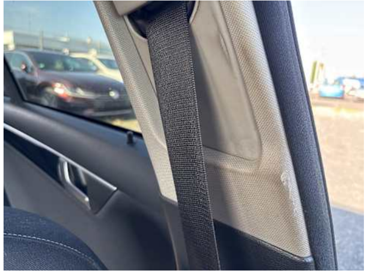
Innenraum (Riss/Bruch, Verschmutzung)
