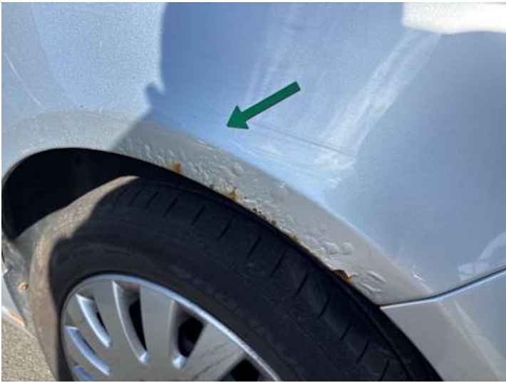
Kotflügel vorne rechts (Delle, Kratzer, Rost)
