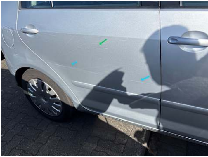
Türe hinten rechts (Kratzer, Delle)
