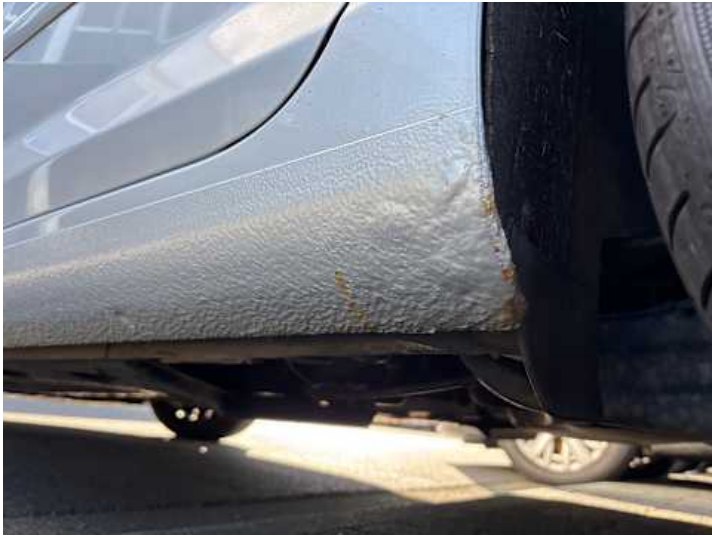
Schweller links (Rost)
