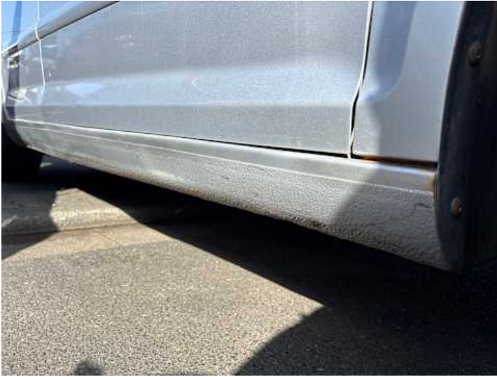
Schweller rechts (Verformung, Rost)
