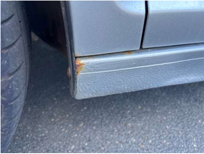
Schweller links (Rost)
