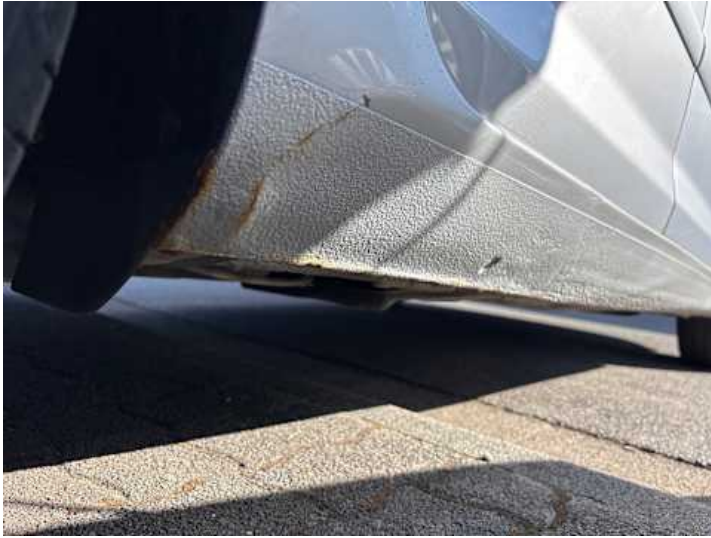
Schweller rechts (Verformung, Rost)
