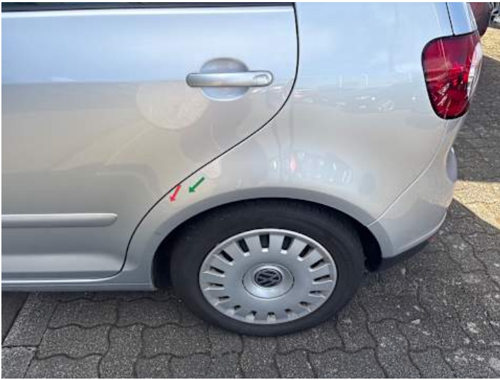
Seitenteil hinten links (Delle, Unsachgemäß instand gesetzt)
