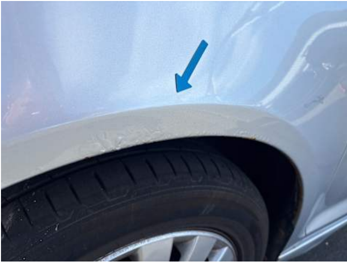
Kotflügel vorne links (Rost)
