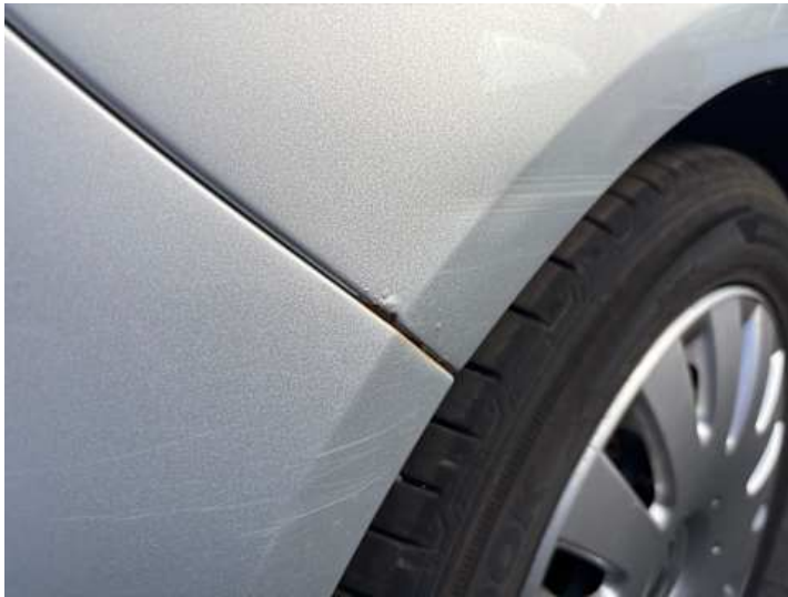
Seitenteil hinten rechts (Rost)
