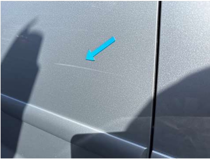
Türe hinten rechts (Kratzer, Delle)
