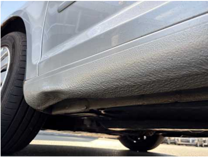
Schweller links (Delle, Verformung)
