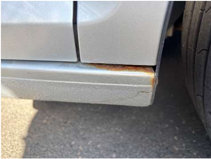
Schweller rechts (Verformung, Rost)
