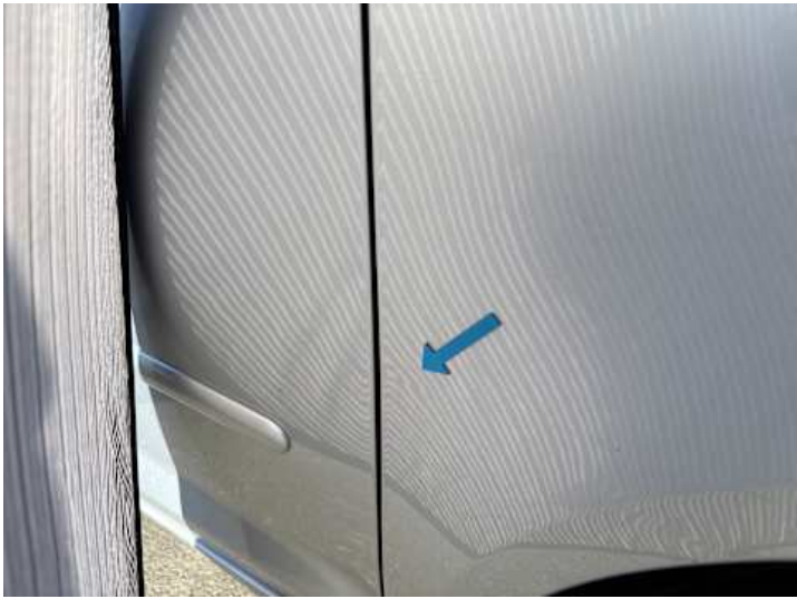
Kotflügel vorne rechts (Delle, Kratzer, Rost)
