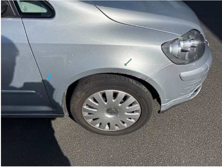
Kotflügel vorne rechts (Delle, Kratzer, Rost)
