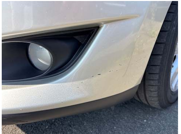
Stoßstange vorne (Kratzer, Lackschaden)
