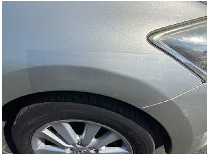
Kotflügel vorne rechts (Unsachgemäß instand gesetzt)
