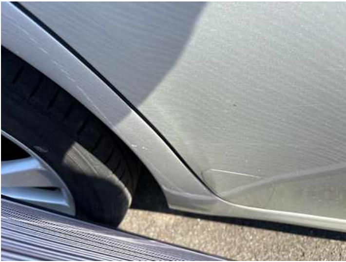
Türe hinten rechts (Delle, Verformung)
