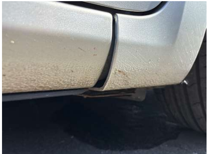
Kotflügel vorne rechts (Verformung, Spaltmaße ungenau)
