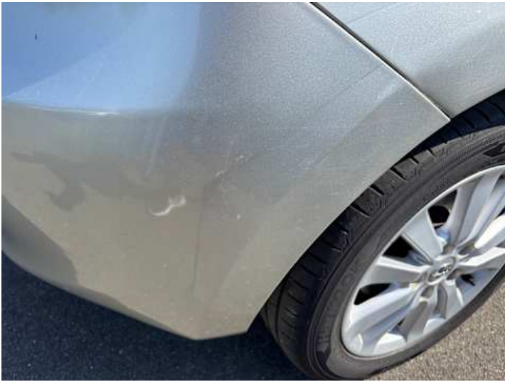
Stoßstange hinten (Unsachgemäß instand gesetzt)
