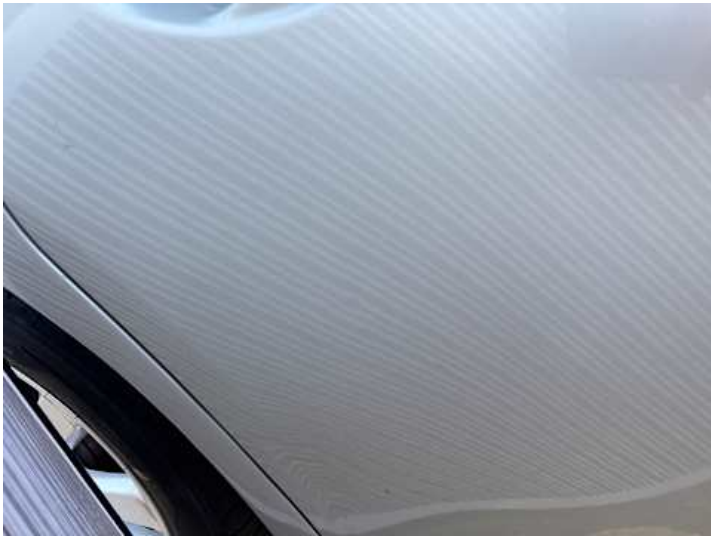
Türe hinten rechts (Delle, Verformung)
