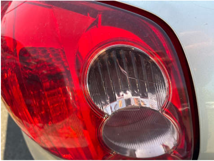
Rücklicht (links) (Riss/Bruch)
