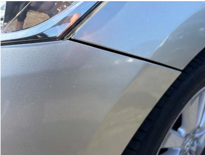
Stoßstange vorne (Spaltmaße ungenau)
