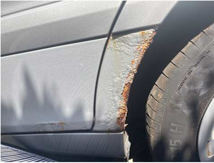
Seitenteil hinten links (Rost, Kratzer)
