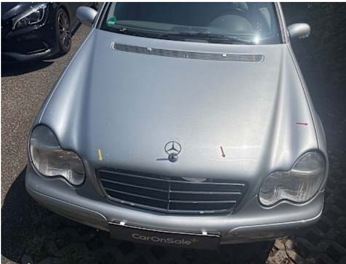
Motorhaube (Kratzer, Unsachgemäß instand gesetzt)
