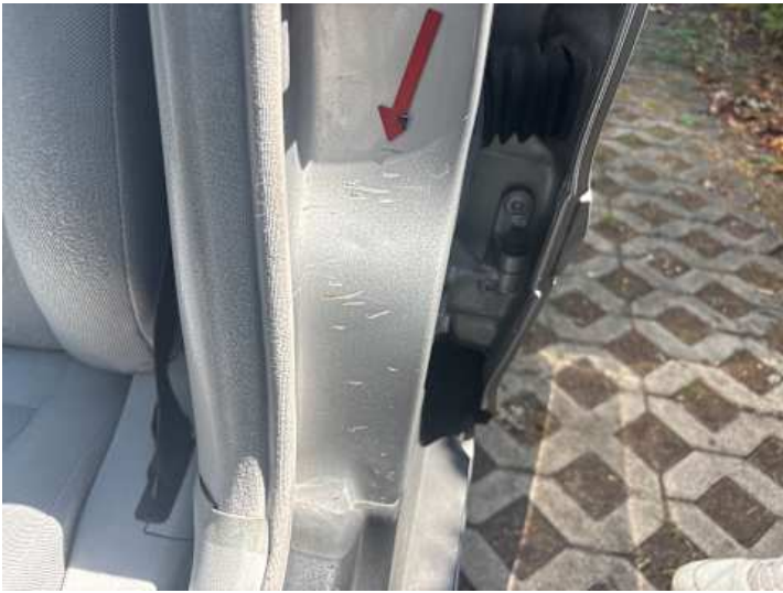
Fahrrertür (Kratzer, Delle)
