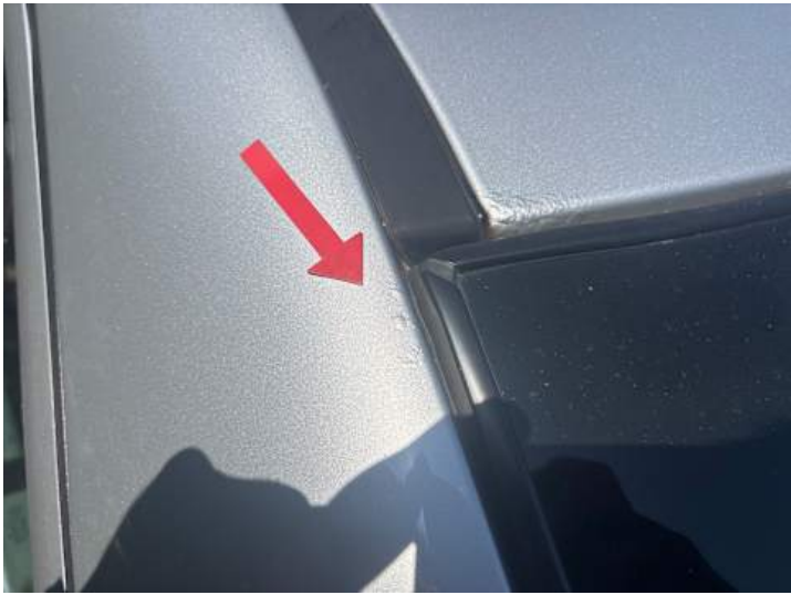
Seitenteil hinten links (Rost)
