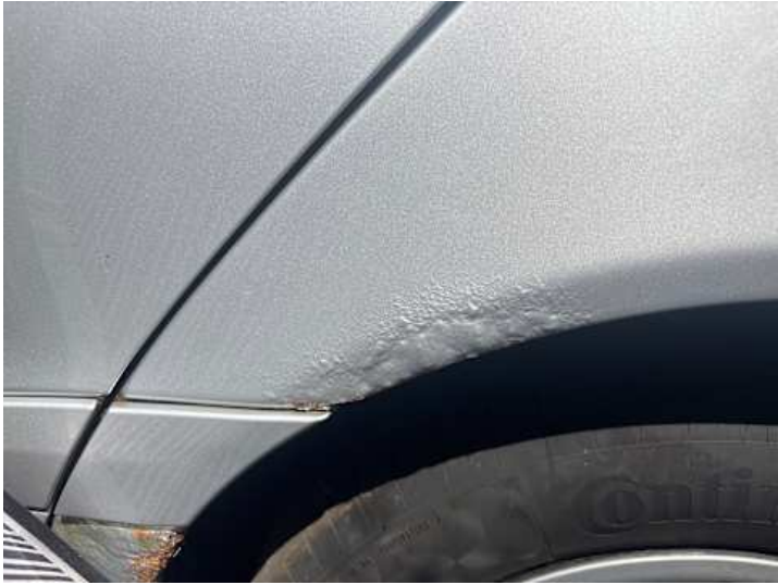
Seitenteil hinten links (Rost, Kratzer)
