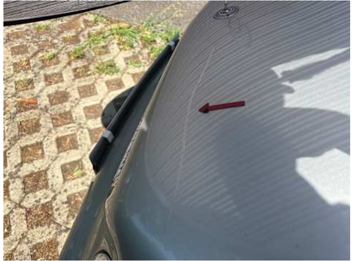
Motorhaube (Kratzer, Unsachgemäß instand gesetzt)
