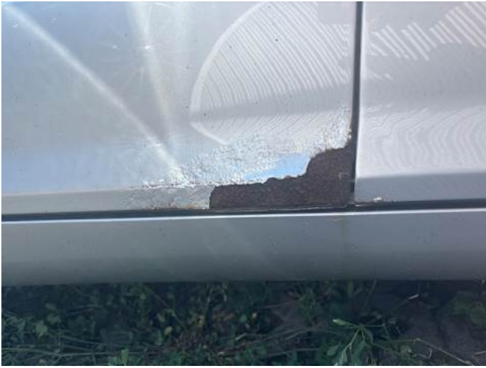
Türe hinten rechts (Rost, Kratzer)
