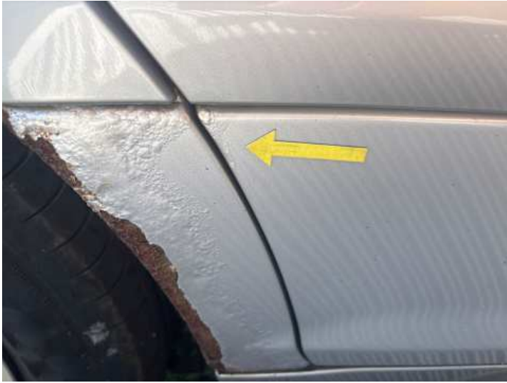
Türe hinten rechts (Rost, Kratzer)
