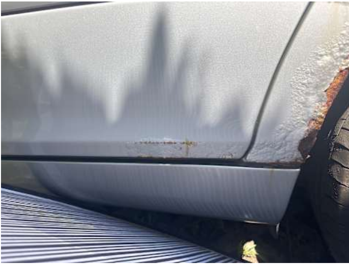
Türe hinten links (Rost)
