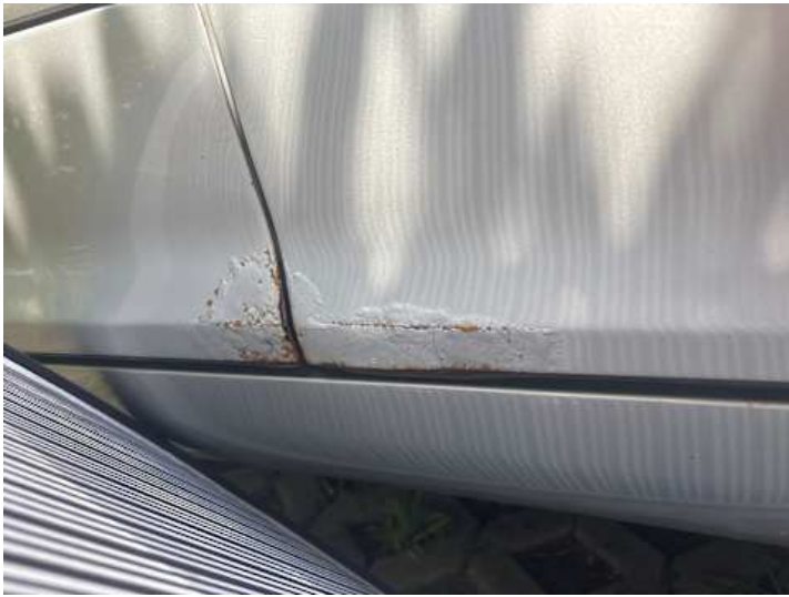
Türe hinten links (Rost)
