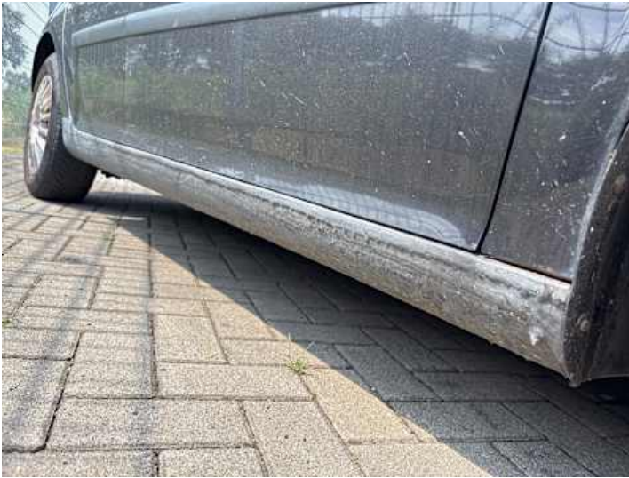
Schweller rechts (Rost, Lackschaden, Unsachgemäß instand gesetzt)
