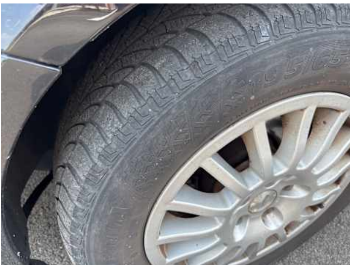
Rad (Ungleichmäßig abgefahren, Riss/Bruch)
