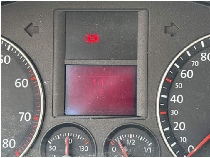
Innenraum (Anderer Schaden): Pixelfehler Kilometerstand nur sehr schwer erkennbar !
