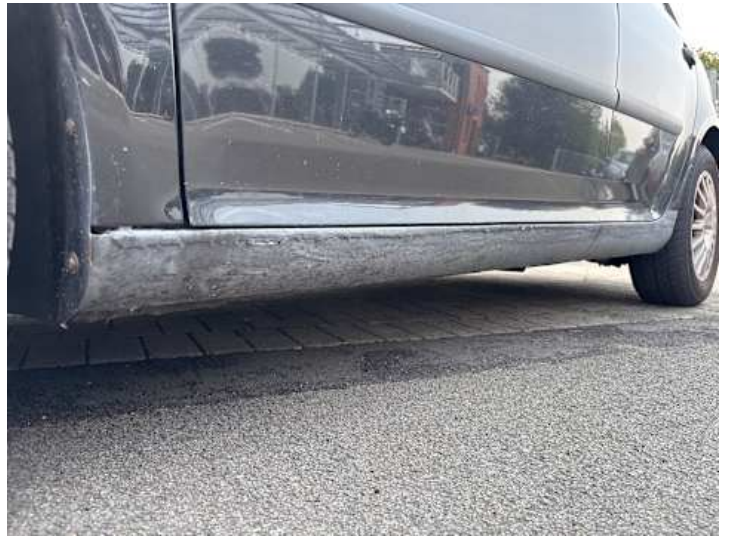
Schweller links (Lackschaden, Rost, Unsachgemäß instand gesetzt)
