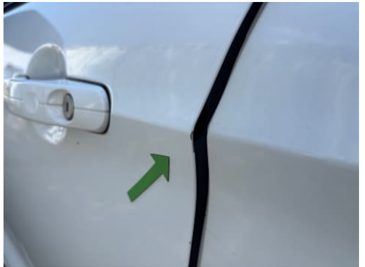
Fahrtür (Delle, Kratzer)
