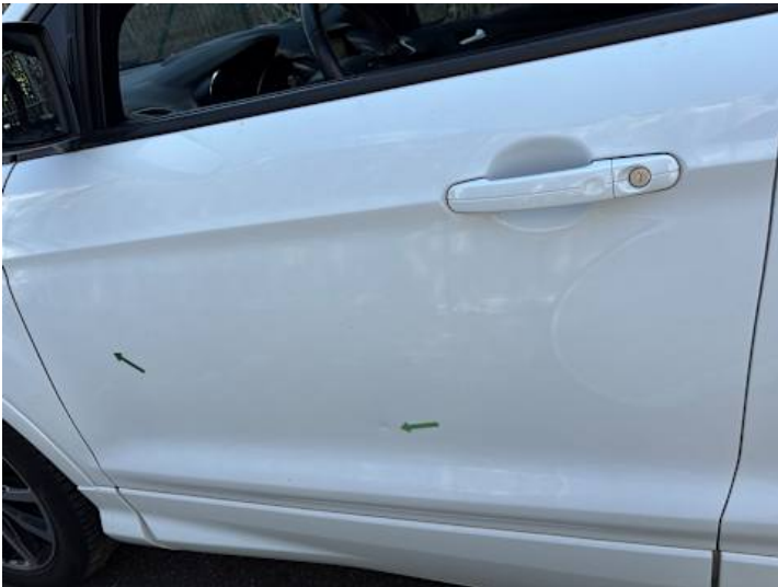
Fahrtür (Delle, Kratzer)
