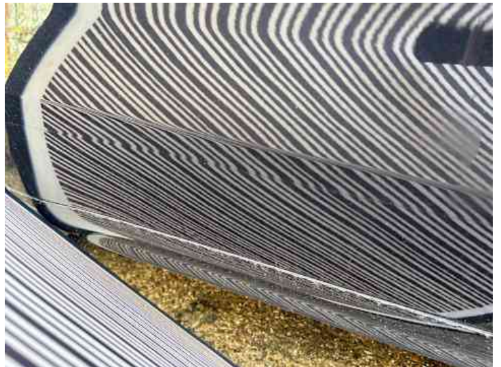
Türe hinten rechts (Verformung)
