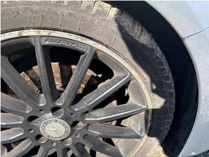
Rad (Kratzer, Kerben, Rost)
