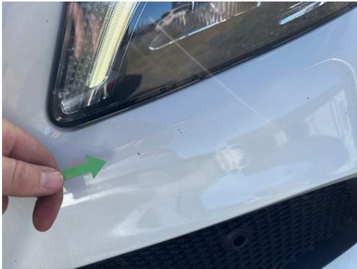
Stoßstange vorne (Steinschlag)
