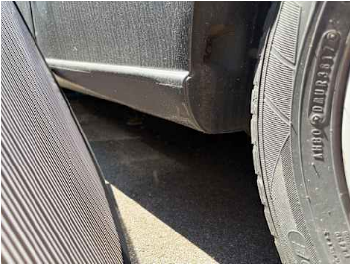
Schweller links (Delle, Verformung)
