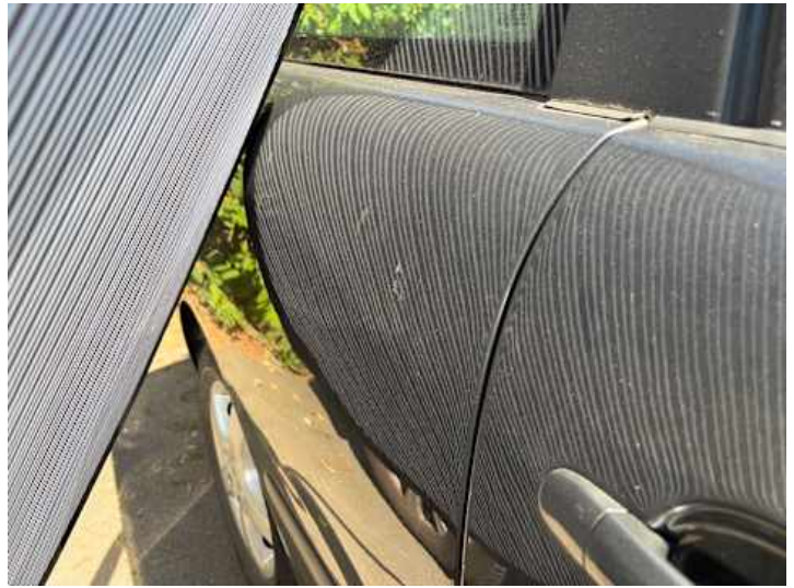
Seitenteil hinten rechts (Delle, Verformung)
