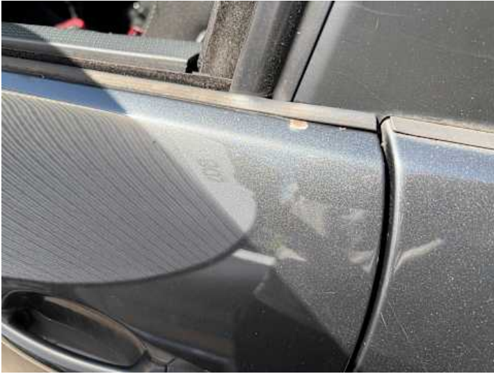
Fahrtür (Lackschaden, Kratzer, Rost)
