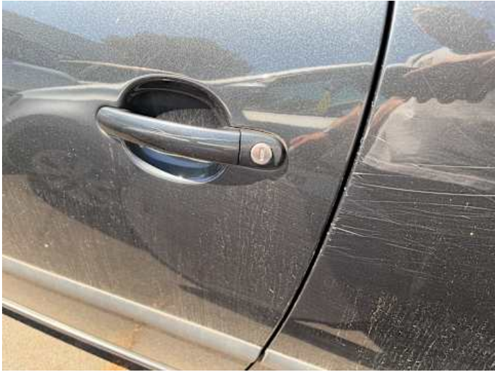
Fahrtür (Lackschaden, Kratzer, Rost)
