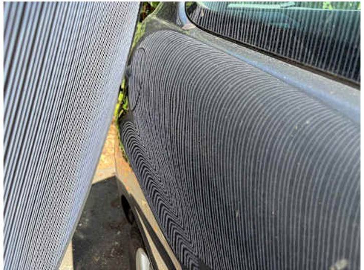
Seitenteil hinten rechts (Delle, Verformung)
