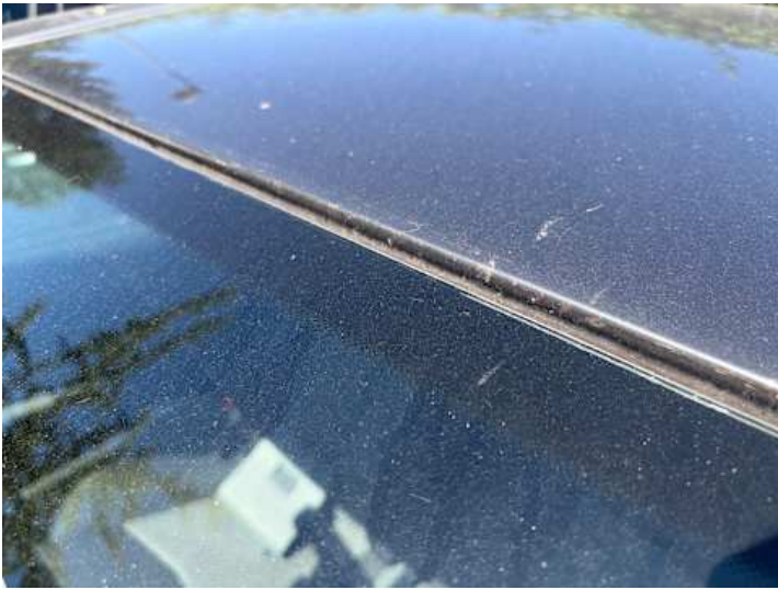
Dach (Lackschaden, Steinschlag)
