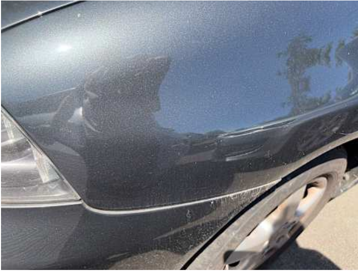
Kotflügel vorne links (Lackschaden, Kratzer)
