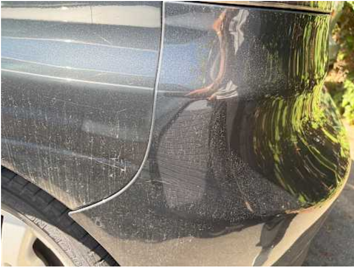
Stoßstange hinten (Spaltmaße ungenau)
