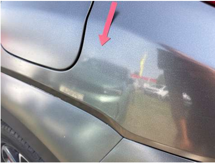
Seitenteil hinten links (Unsachgemäß instand gesetzt, Kratzer)
