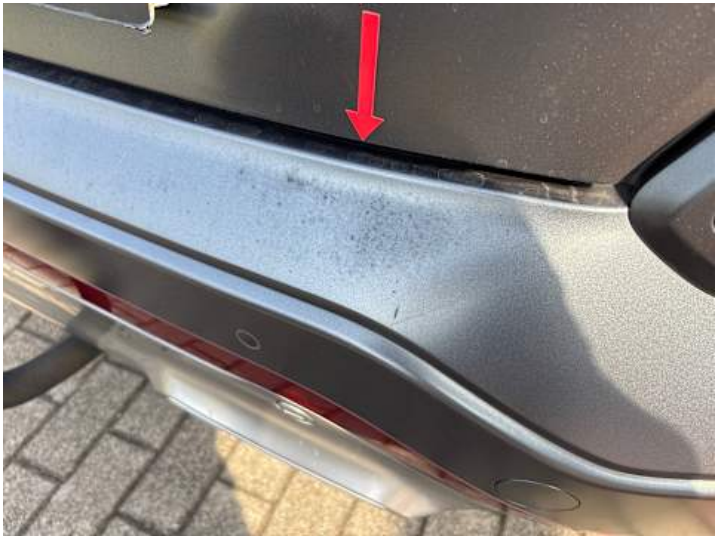
Stoßstange hinten (Unsachgemäß instand gesetzt)
