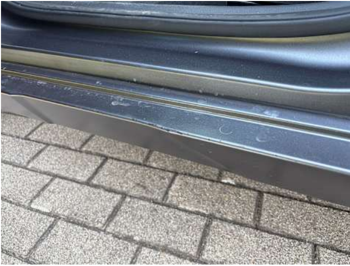
Schweller links (Kratzer)
