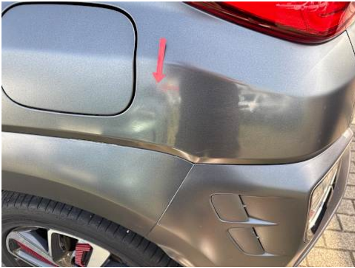
Seitenteil hinten links (Unsachgemäß instand gesetzt, Kratzer)
