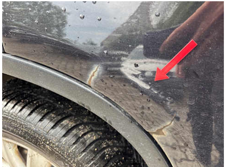
Türe hinten rechts (Lackschaden, Rost, Unsachgemäß instand gesetzt)
