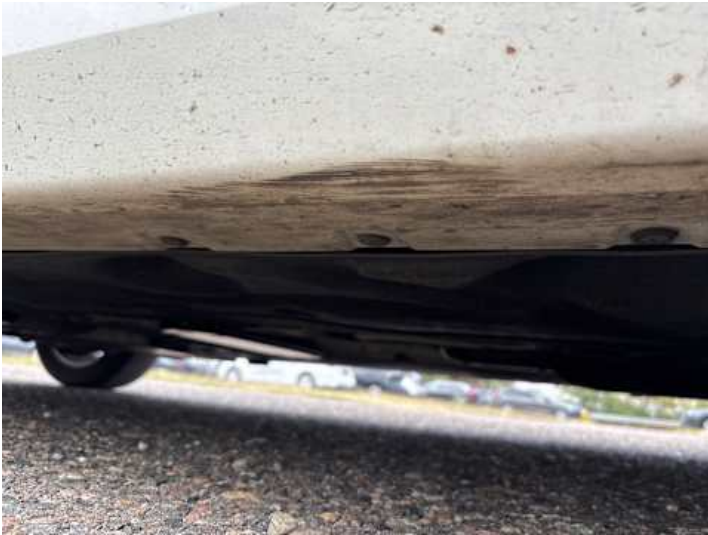
Schweller rechts (Kratzer, Lackschaden)
