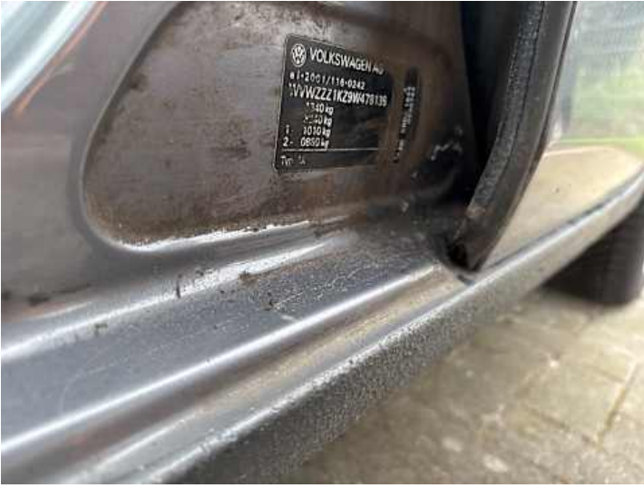
Schweller links (Lackschaden, Rost, Unsachgemäß instand gesetzt)
