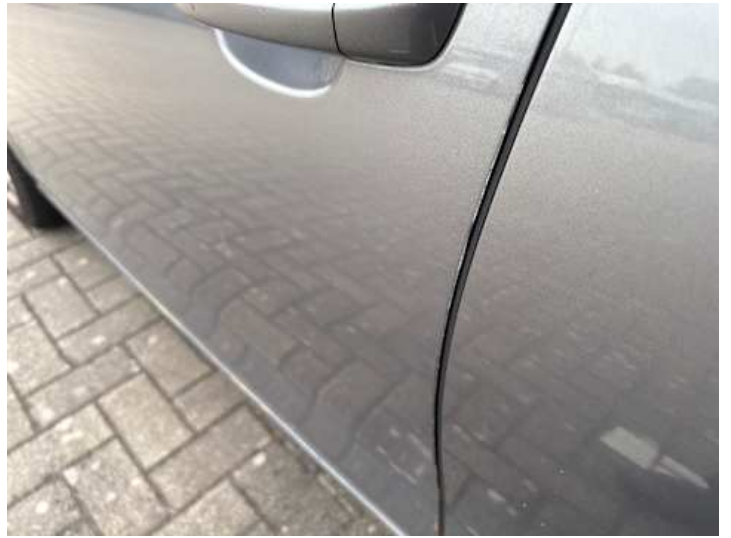
Fahrtür (Rost, Lackschaden)
