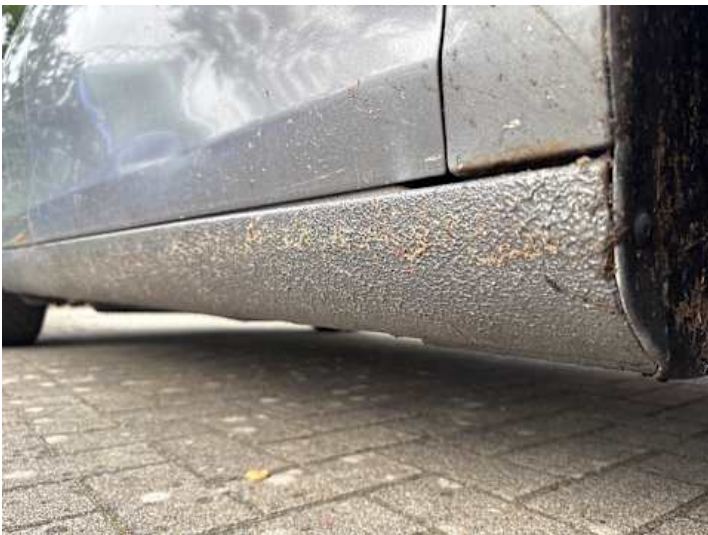
Schweller rechts (Lackschaden, Unsachgemäß instand gesetzt)
