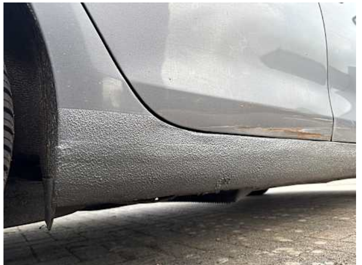
Schweller rechts (Lackschaden, Unsachgemäß instand gesetzt)
