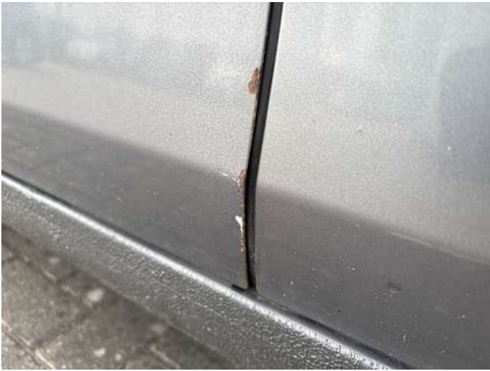
Fahrtür (Rost, Lackschaden)
