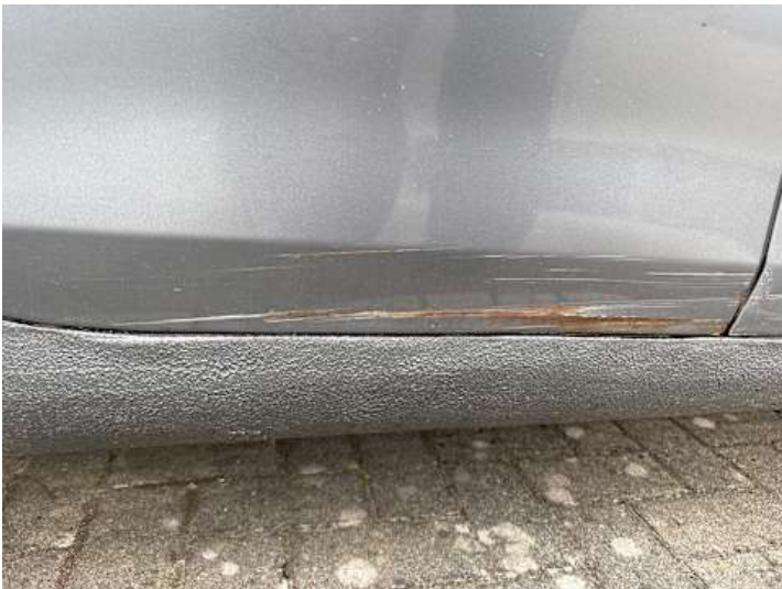
Türe hinten rechts (Kratzer, Lackschaden, Rost)
