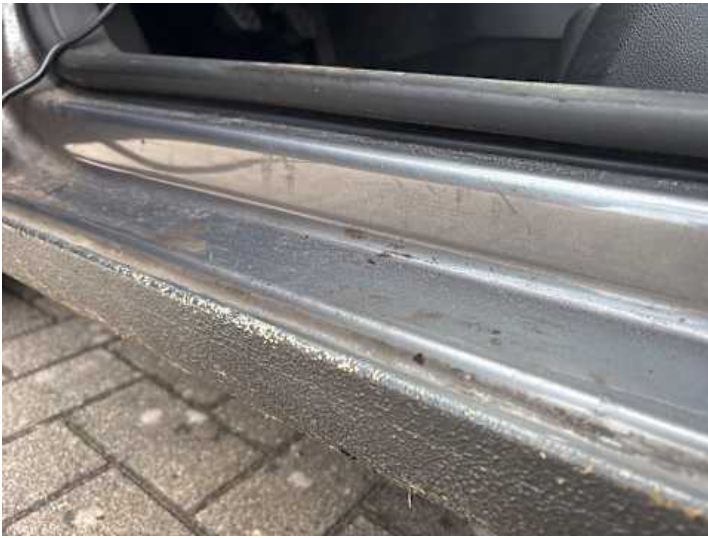
Schweller links (Lackschaden, Rost, Unsachgemäß instand gesetzt)
