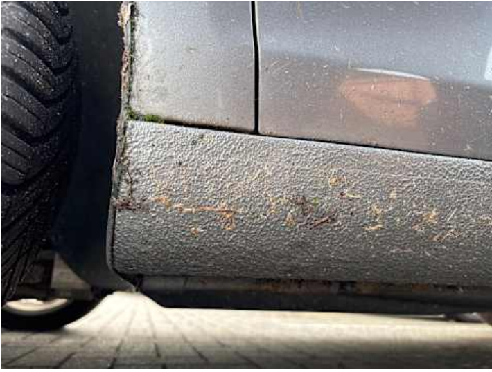
Schweller links (Lackschaden, Rost, Unsachgemäß instand gesetzt)
