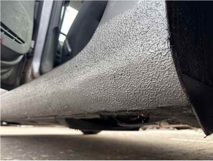
Schweller links (Lackschaden, Rost, Unsachgemäß instand gesetzt)
