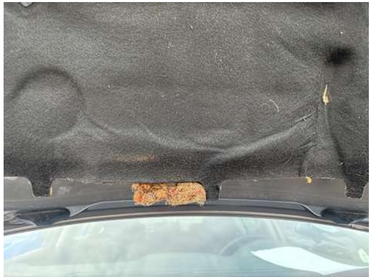
Motorhaube (Anderer Schaden): Motordämmung beschädigt
