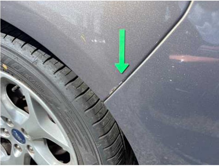
Seitenteil hinten links (Delle, Lackschaden)
