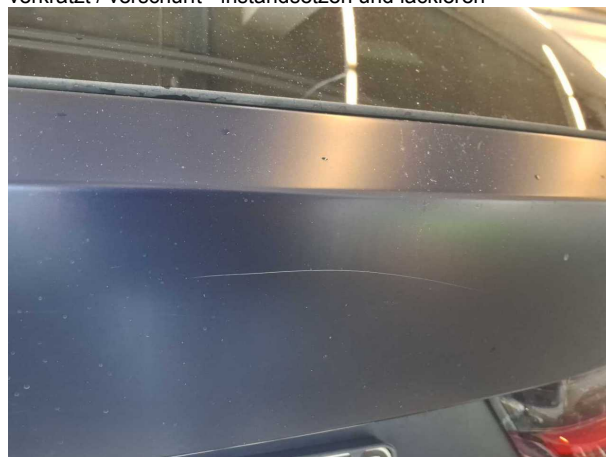
Beschädigung 8: Heckklappe/-tür: Heckklappe - Kratzer - lackieren
