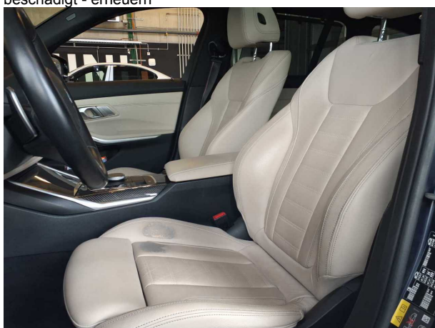
Beschädigung 6: Sitz vorn: Sitzbezug links - beschädigt - erneuern
