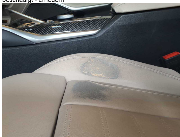
Beschädigung 6: Sitz vorn: Sitzbezug links - beschädigt - erneuern
