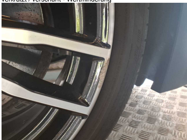
Beschädigung 5: Rad/Reifen: Leichtmetallfelge vorn rechts - beschädigt - erneuern
