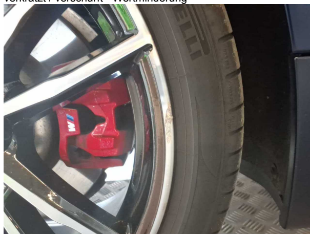
Beschädigung 4: Rad/Reifen: Leichtmetallfelge hinten recht... verkratzt / verschürft - Wertminderung
