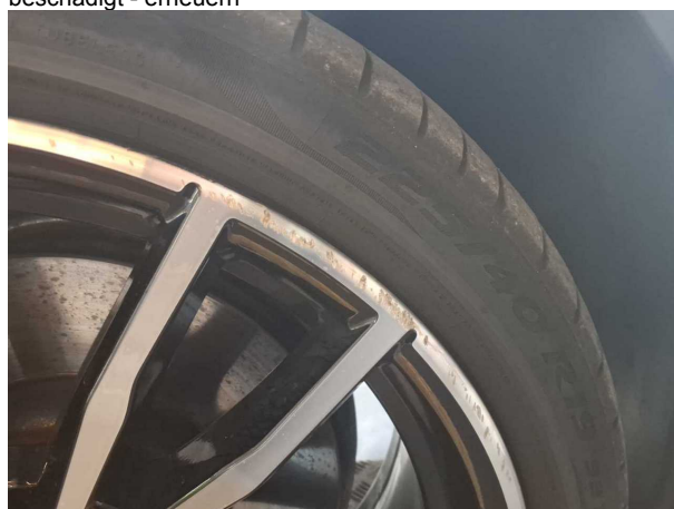
Beschädigung 5: Rad/Reifen: Leichtmetallfelge vorn rechts - beschädigt - erneuern
