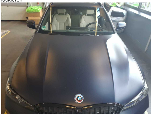
Beschädigung 9: Motorhaube: Motorhaube - Kratzer - lackieren
