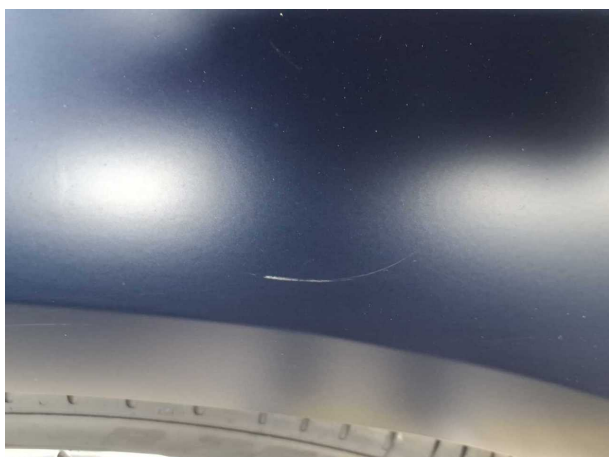
Beschädigung 10: Seitenwand links: Seitenwand - Kratzer - lackieren
