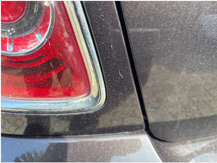
Seitenteil hinten links (Lackschaden, Kratzer, Delle)
