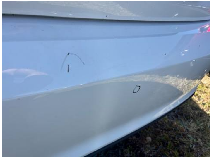
Stoßstange hinten (Lackschaden, Kratzer)
