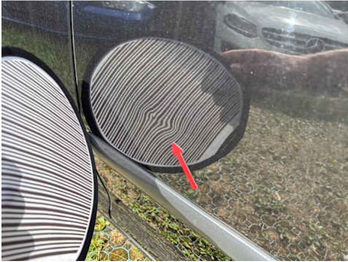
Türe hinten links (Kratzer, Delle)
