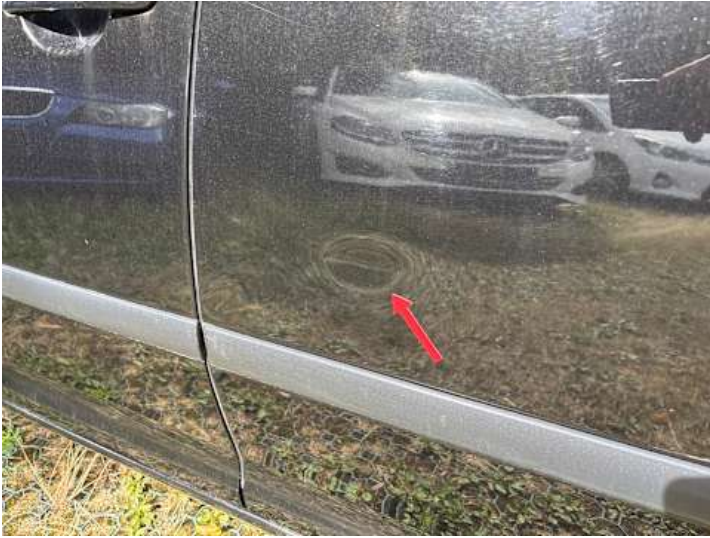
Türe hinten links (Kratzer, Delle)
