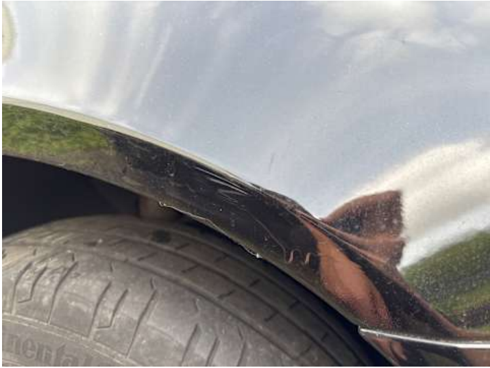
Kotflügel vorne rechts (Unsachgemäß instand gesetzt)
