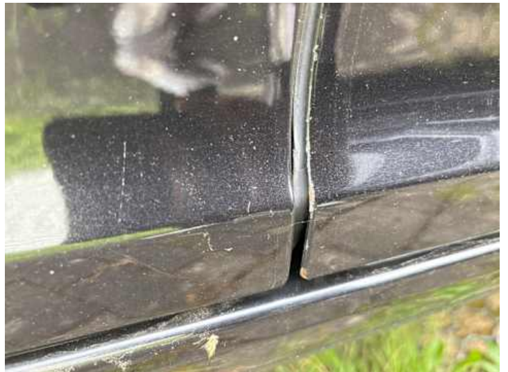
Beifahrtür (Kratzer, Rost)
