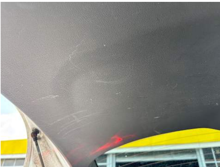
Innenraum (Verschmutzung, Verschleiß)
