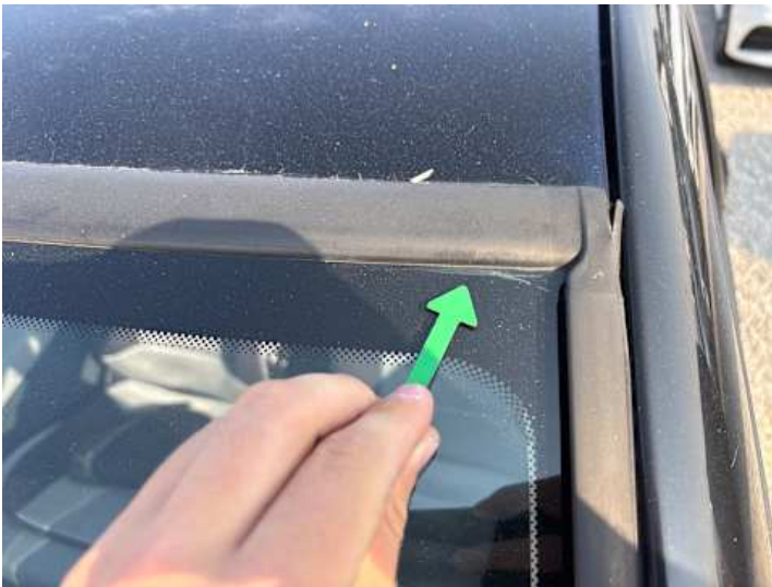
Windschutzscheibe (Anderer Schaden): Ablösung
