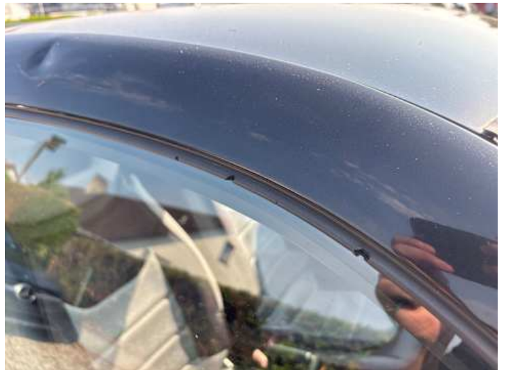
Beifahrertür (Anderer Schaden): Dichtung gerissen
