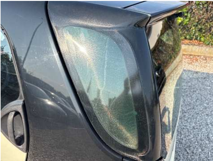
Seitenteil hinten links (Ausgeblichen/Matt, Kratzer)
