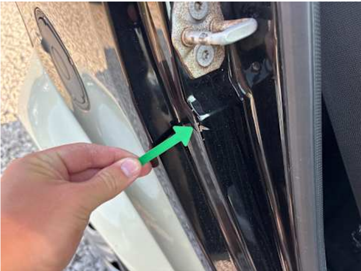
Seitenteil hinten rechts (Kratzer, Rost)
