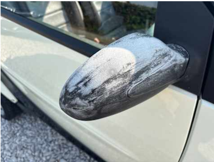
Beifahrertür (Lackschaden, Ausgeblichen/Matt)
