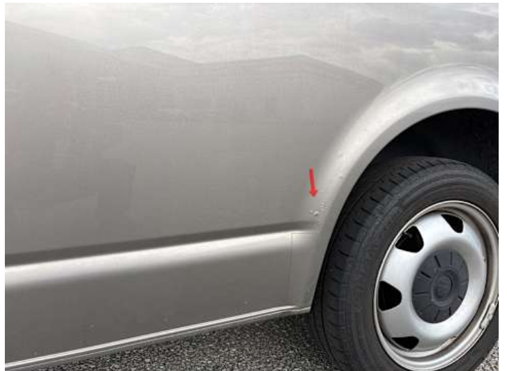
Seitenteil hinten links (Rost)
