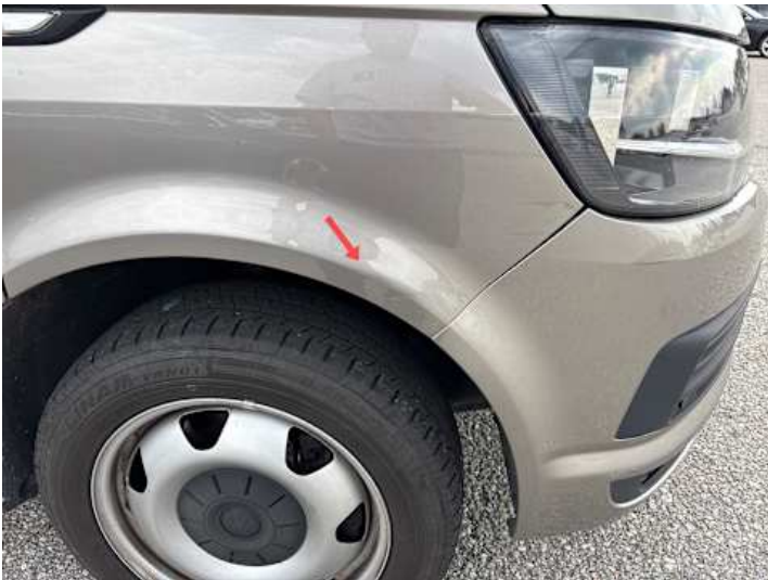
Kotflügel vorne rechts (Delle, Lackschaden)
