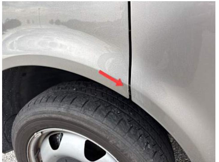
Kotflügel vorne links (Steinschlag, Lackschaden)
