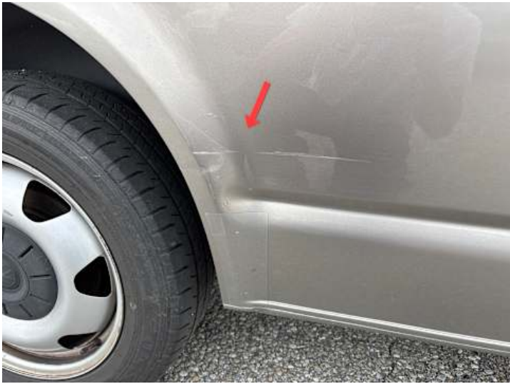
Seitenteil hinten rechts (Rost, Lackschaden, Delle)
