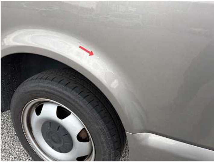
Seitenteil hinten links (Rost)
