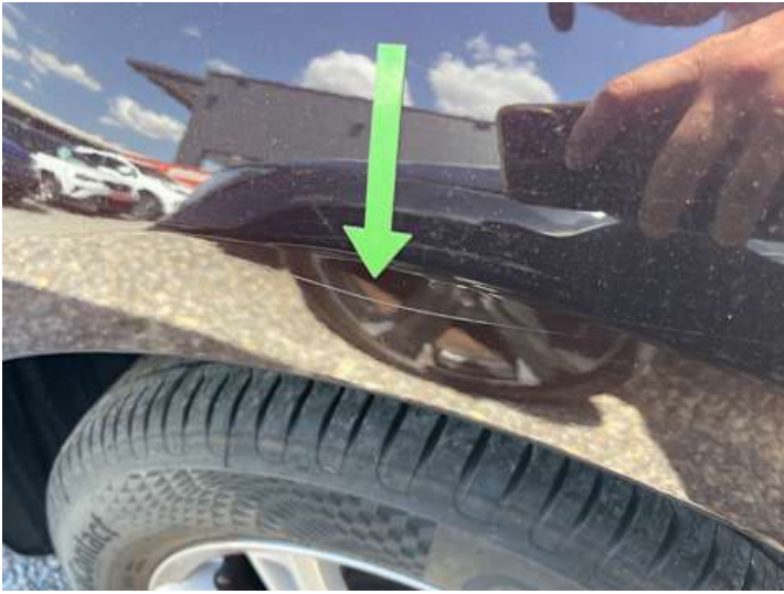
Seitenteil hinten links (Lackschaden, Kratzer)
