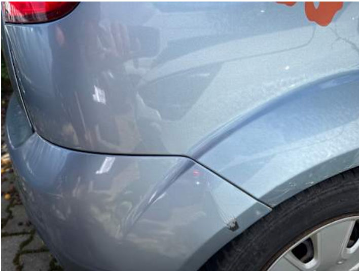
Stoßstange hinten (Riss/Bruch, Lackschaden, Spaltmaße ungenau)
