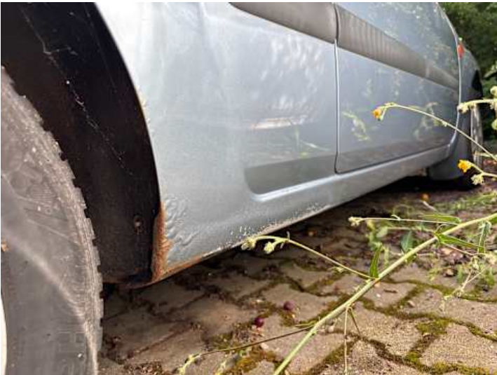
Schweller rechts (Rost)
