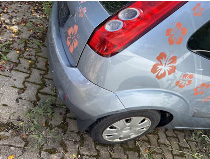
Stoßstange hinten (Riss/Bruch, Lackschaden, Spaltmaße ungenau)
