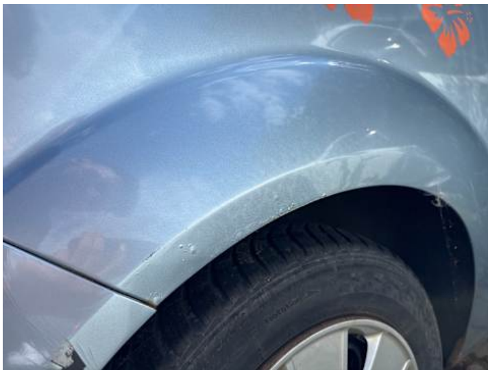
Seitenteil hinten rechts (Rost)
