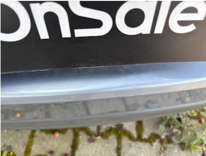
Stoßstange hinten (Riss/Bruch)
