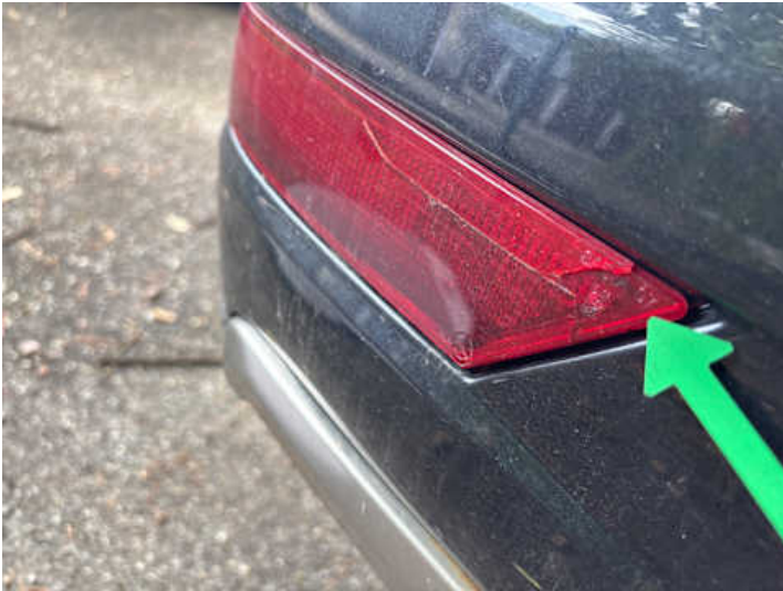
Stoßstange hinten (Riss/Bruch)
