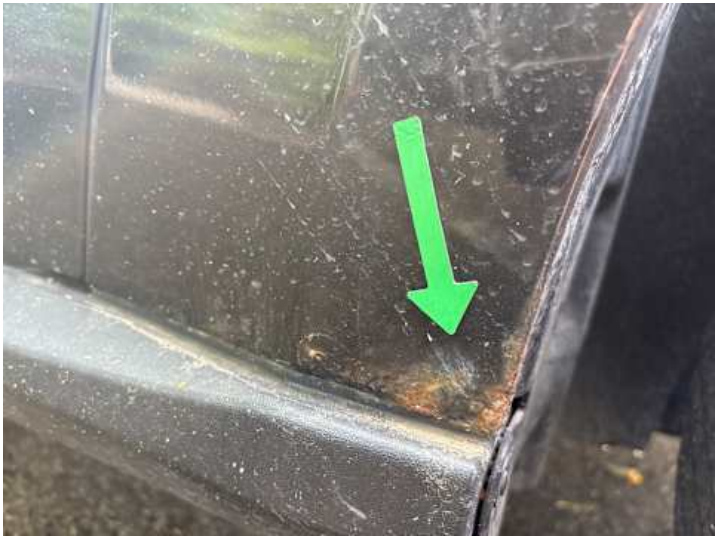
Kotflügel vorne rechts (Rost)
