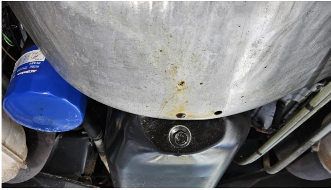
Motor Ölverlust, prüfen
