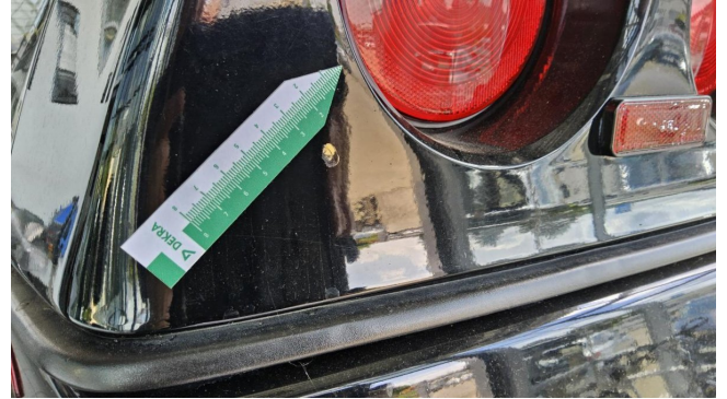
Verkleidung Rückleuchten, links, zerkratzt, SMART
