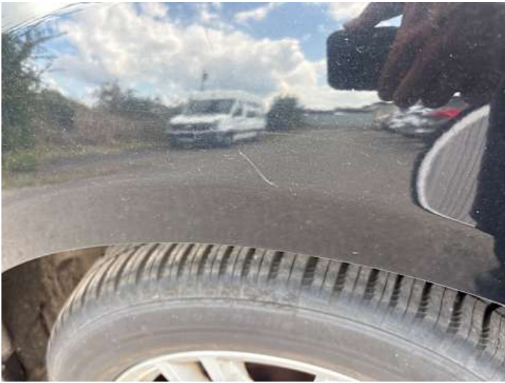
Seitenteil hinten rechts (Kratzer)
