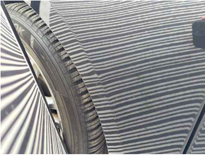
Kotflügel vorne links (Delle)
