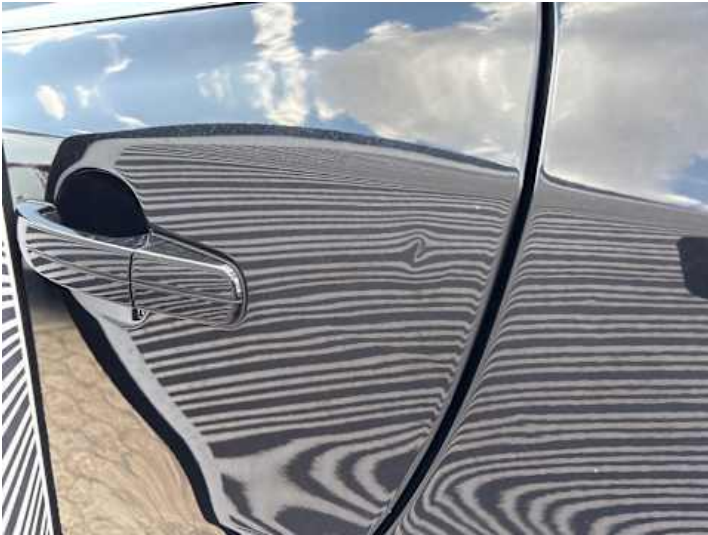
Türe hinten links (Delle, Kratzer)
