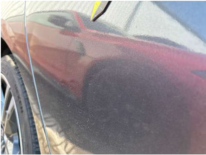
Türe hinten rechts (Unsachgemäß instand gesetzt)
