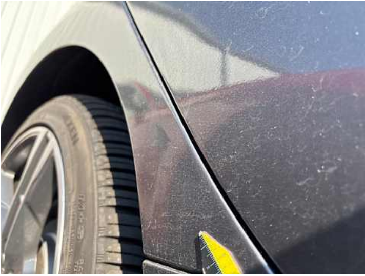
Seitenteil hinten rechts (Unsachgemäß instand gesetzt)
