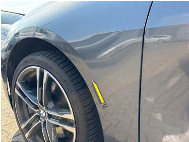
Kotflügel vorne links (Unsachgemäß instand gesetzt)
