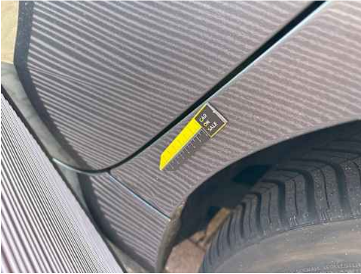
Seitenteil hinten links (Unsachgemäß instand gesetzt)
