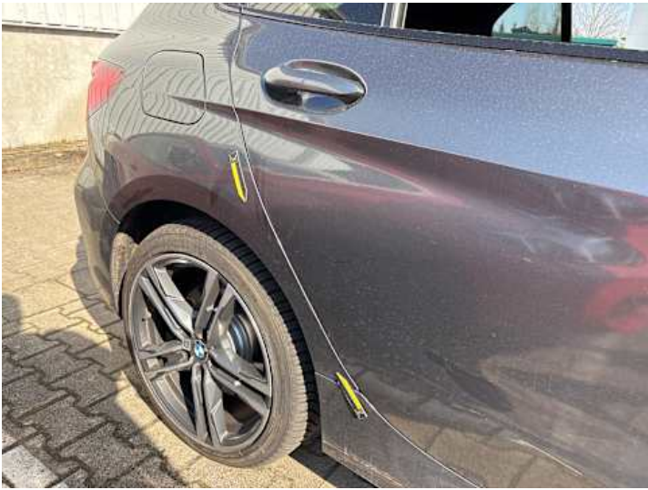
Seitenteil hinten rechts (Unsachgemäß instand gesetzt)
