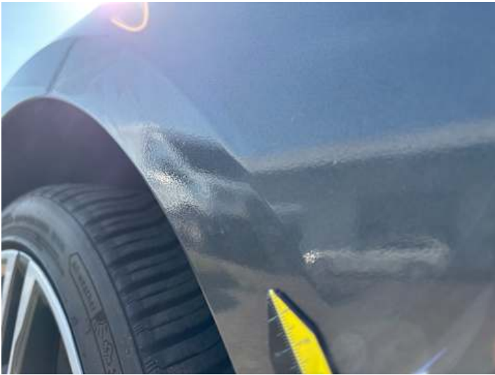
Kotflügel vorne links (Unsachgemäß instand gesetzt)
