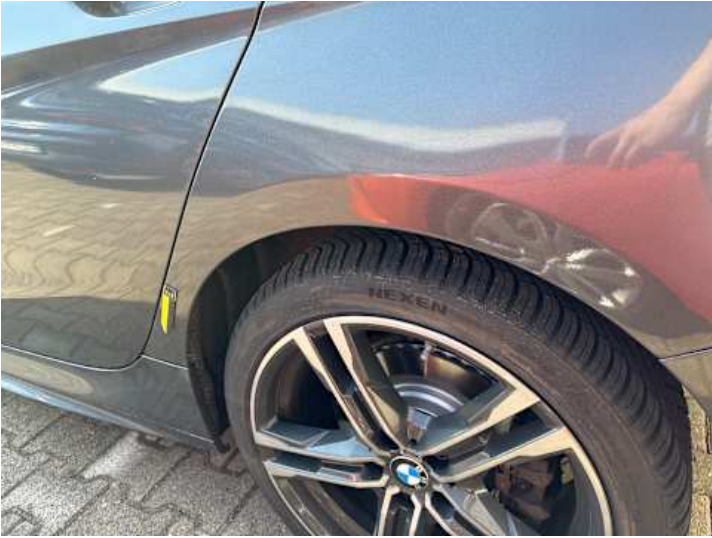
Seitenteil hinten links (Unsachgemäß instand gesetzt)
