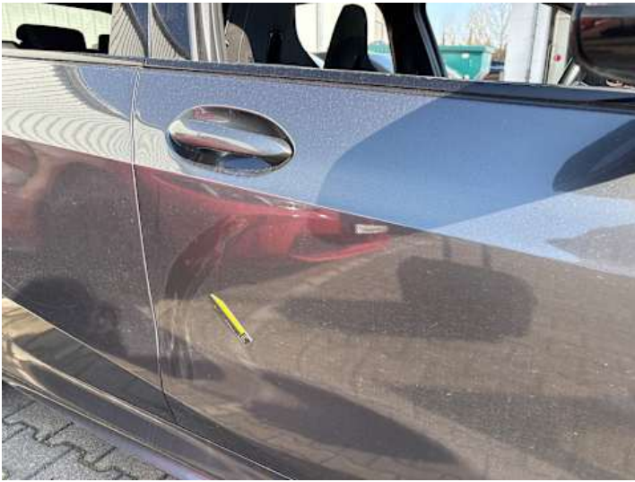
Beifahrertür (Unsachgemäß instand gesetzt)
