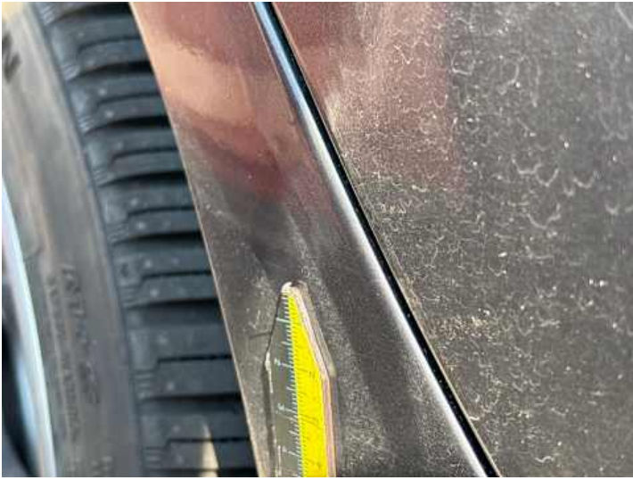
Seitenteil hinten rechts (Unsachgemäß instand gesetzt)
