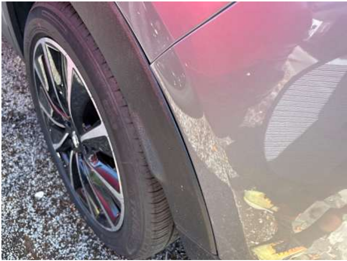
Seitenteil hinten links (Spaltmaße ungenau)
