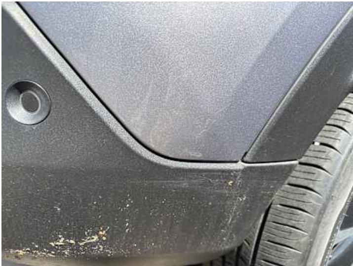
Stoßstange hinten (Unsachgemäß instand gesetzt, Lackschaden)
