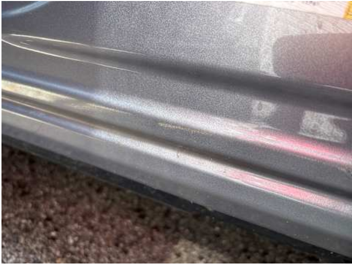
Schweller links (Kratzer)
