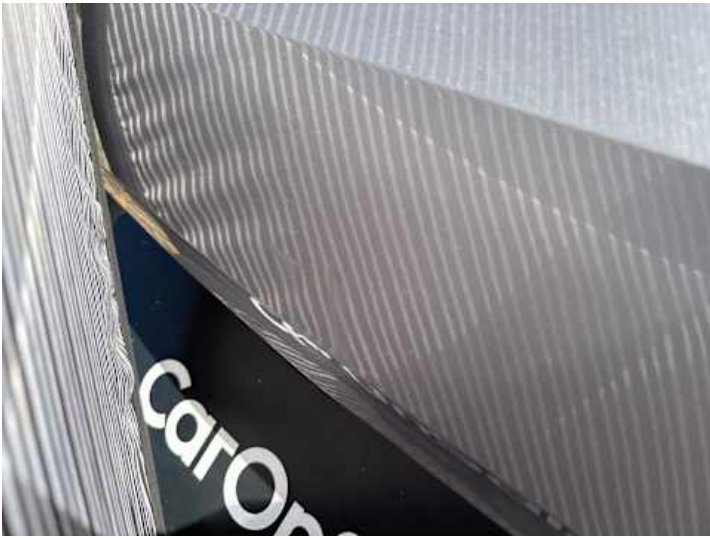
Heckklappe (Kratzer, Delle)
