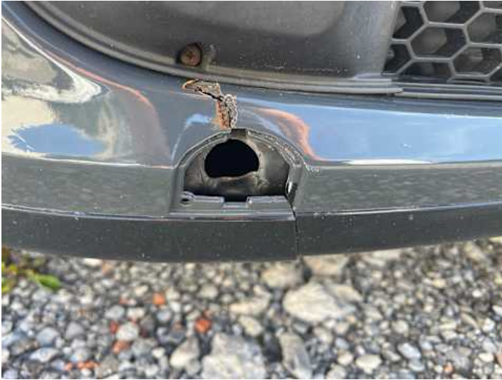
Stoßstange vorne (Riss/Bruch)
