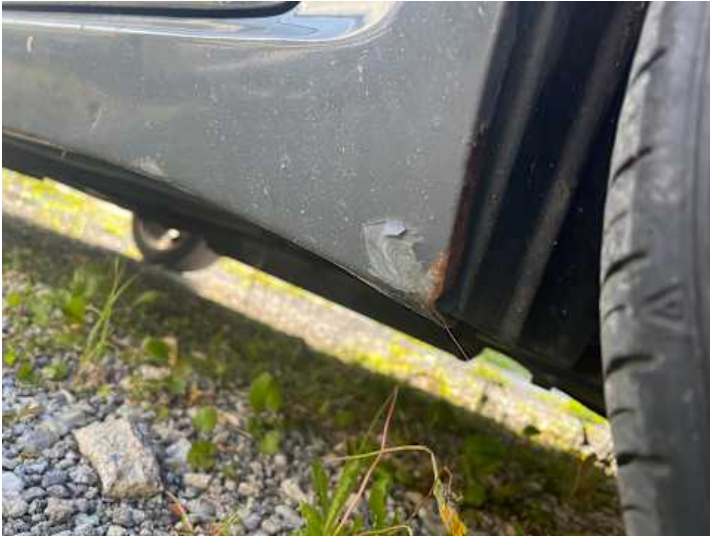
Schweller rechts (Rost)
