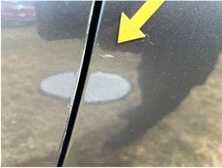
Seitenteil hinten links (Lackschaden)
