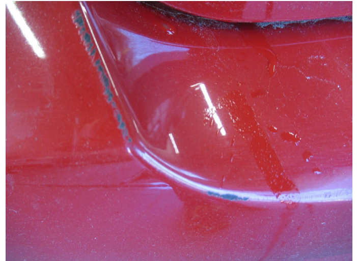
Bild 2: Außen, Stoßfänger hinten - Lackierung, verschrammt, lackieren mit Lackaufbau
