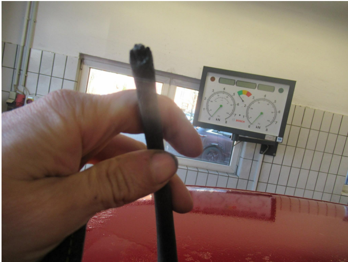
Bild 1: Außen, Dach - Antenne, Tierverschiss, erneuern
