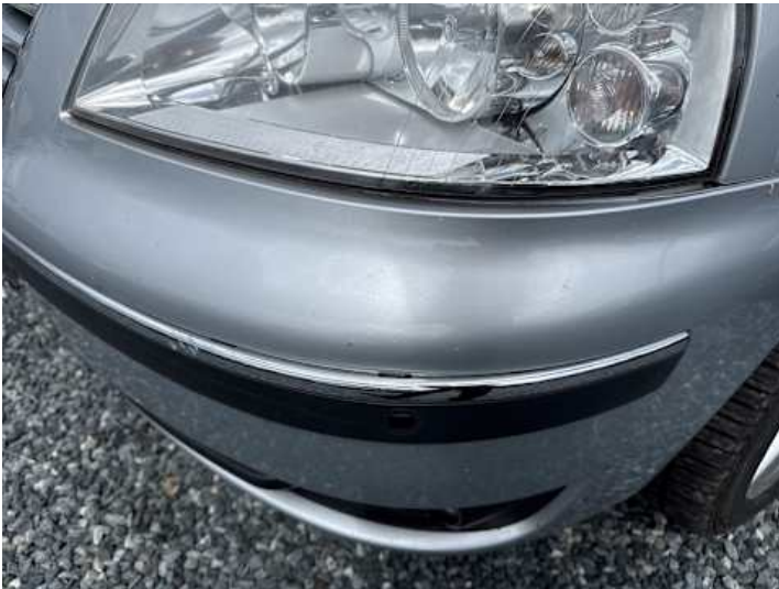
Stoßstange vorne (Riss/Bruch)
