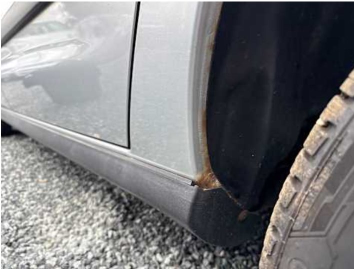
Schweller links (Rost)
