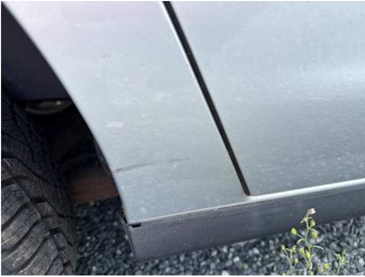
Seitenteil hinten rechts (Kratzer, Verformung, Rost)
