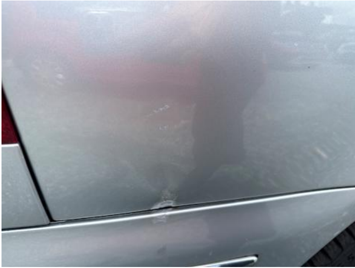
Seitenteil hinten rechts (Kratzer, Verformung, Rost)
