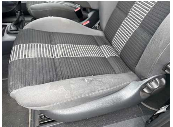
Innenraum (Verschleiß, Riss/Bruch)
