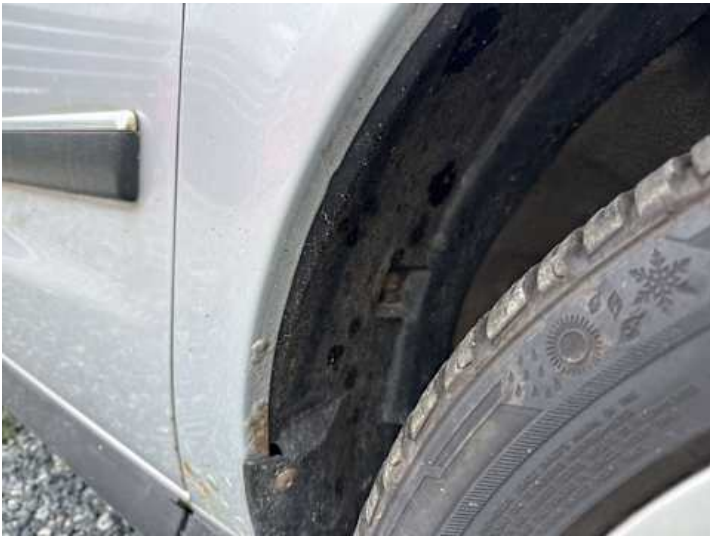
Kotflügel vorne rechts (Rost)
