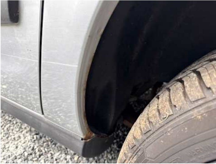
Seitenteil hinten links (Rost, Kratzer)
