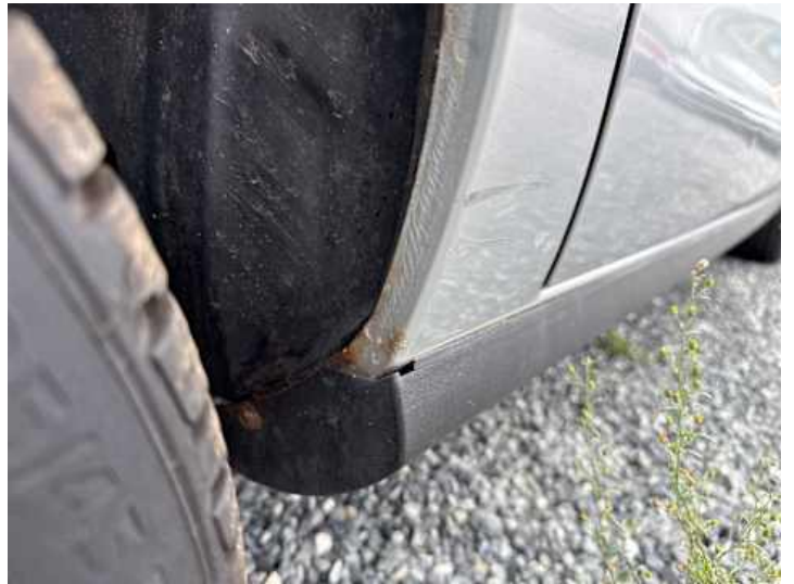
Schweller rechts (Rost)
