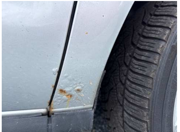
Kotflügel vorne rechts (Rost)
