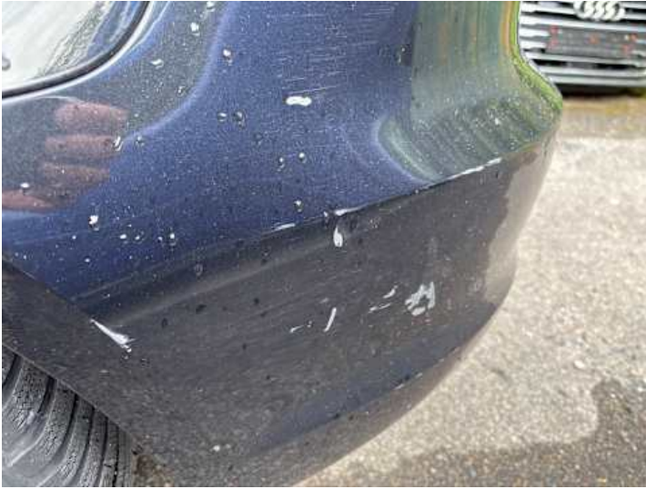
Stoßstange hinten (Lackschaden, Kratzer)
