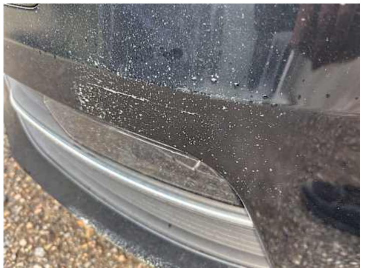
Stoßstange vorne (Kratzer, Lackschaden)
