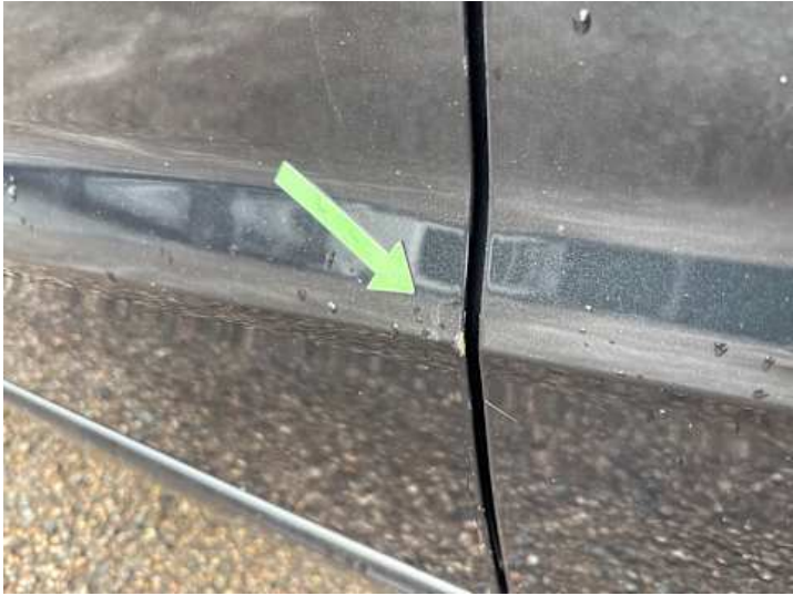
Fahrtür (Rost, Lackschaden)
