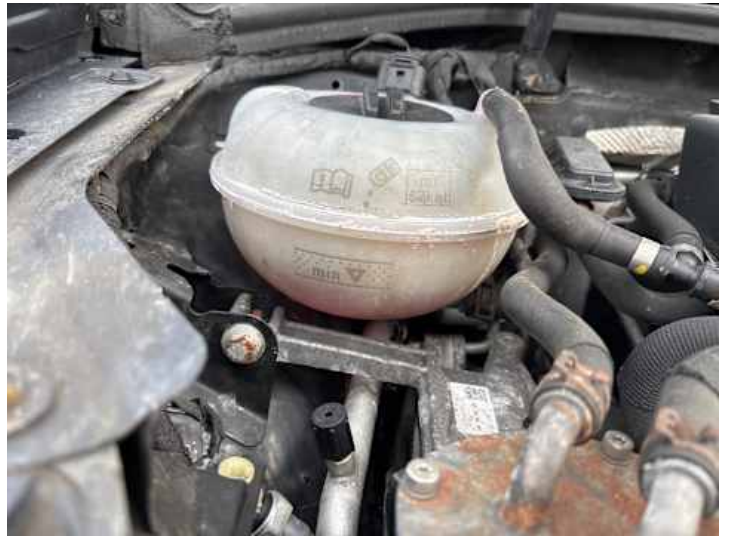
Motorhaube (Anderer Schaden): Kühlmittelbehälter unter Minimum
