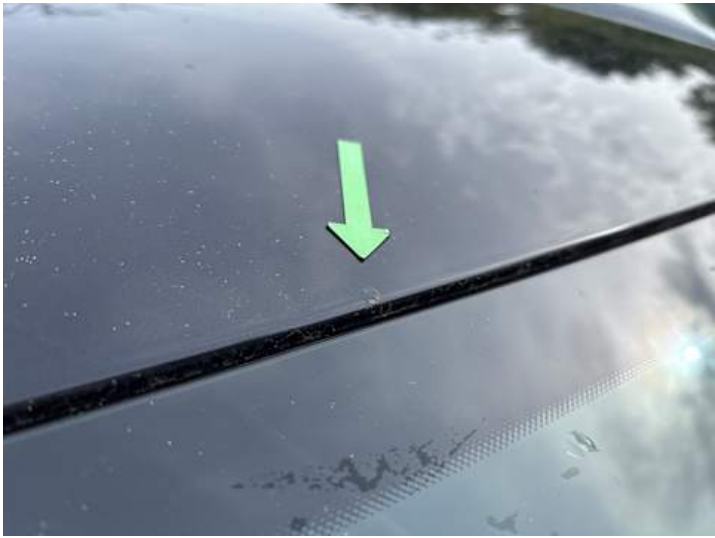
Dach (Rost, Lackschaden)
