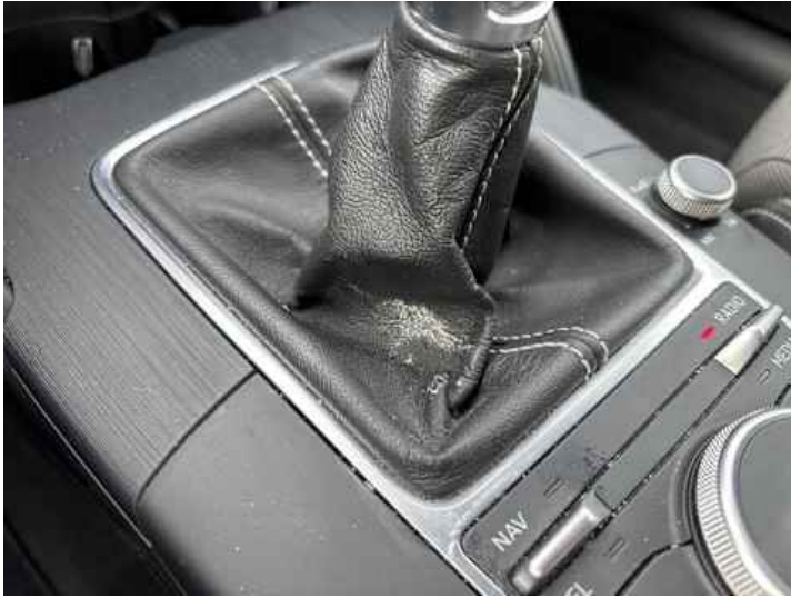
Innenraum (Verschmutzung, Verschleiß)
