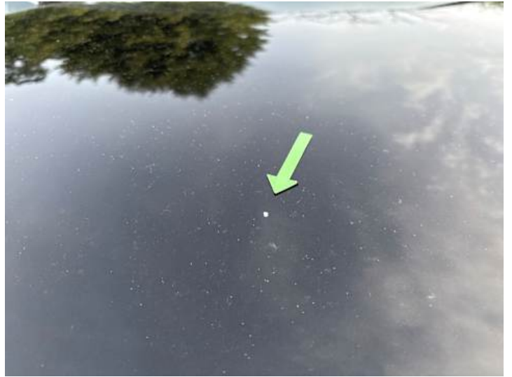
Motorhaube (Steinschlag, Lackschaden)
