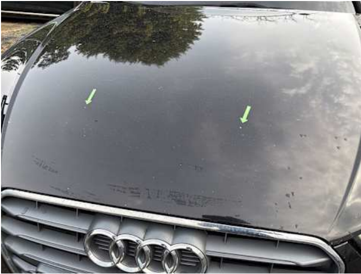
Motorhaube (Steinschlag, Lackschaden)
