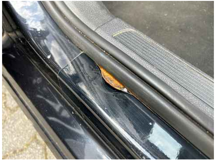
Schweller links (Rost, Lackschaden)
