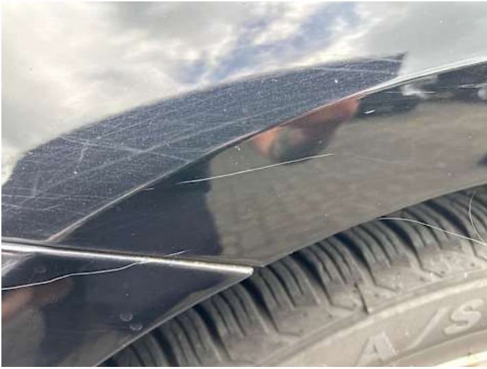
Kotflügel vorne links (Delle, Kratzer)
