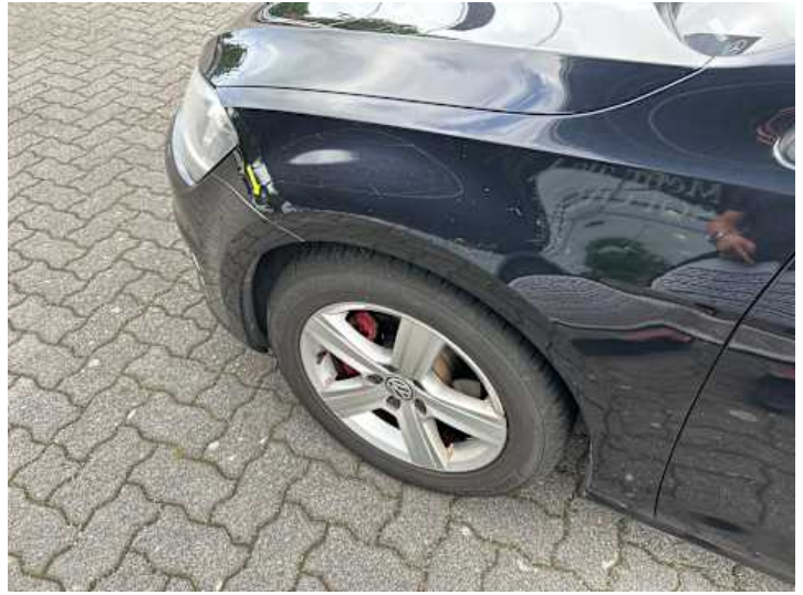
Kotflügel vorne links (Delle, Kratzer)
