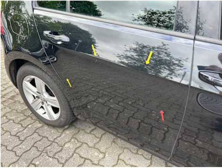
Türe hinten rechts (Lackschaden, Kratzer)
