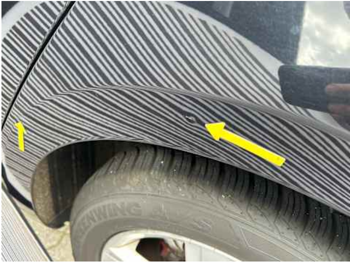
Seitenteil hinten links (Kratzer, Delle)
