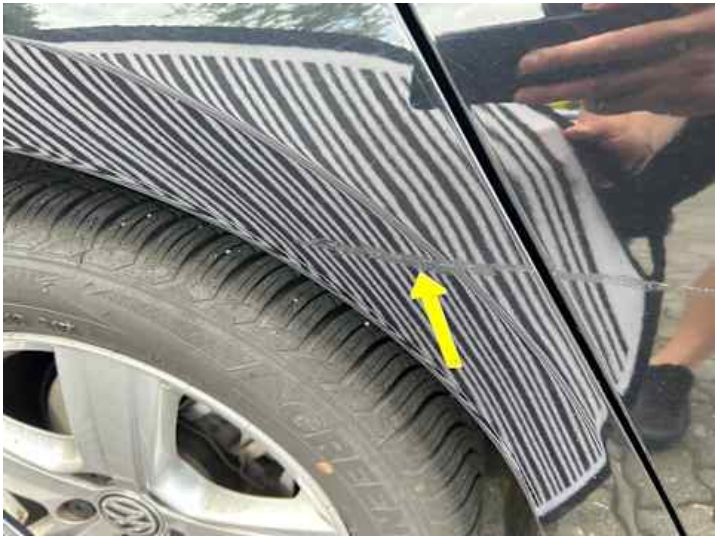
Seitenteil hinten rechts (Kratzer, Lackschaden)
