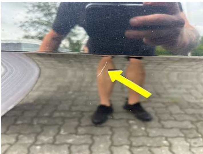
Türe hinten rechts (Lackschaden, Kratzer)
