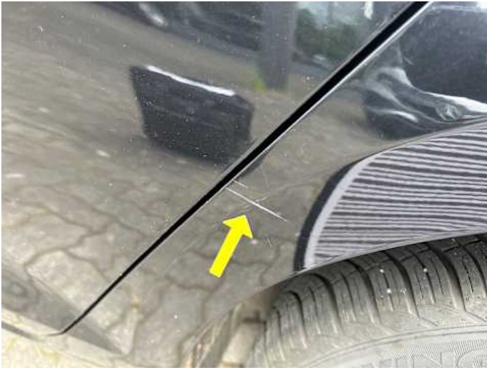
Seitenteil hinten links (Kratzer, Delle)
