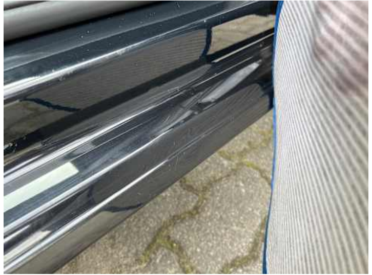
Schweller rechts (Delle)
