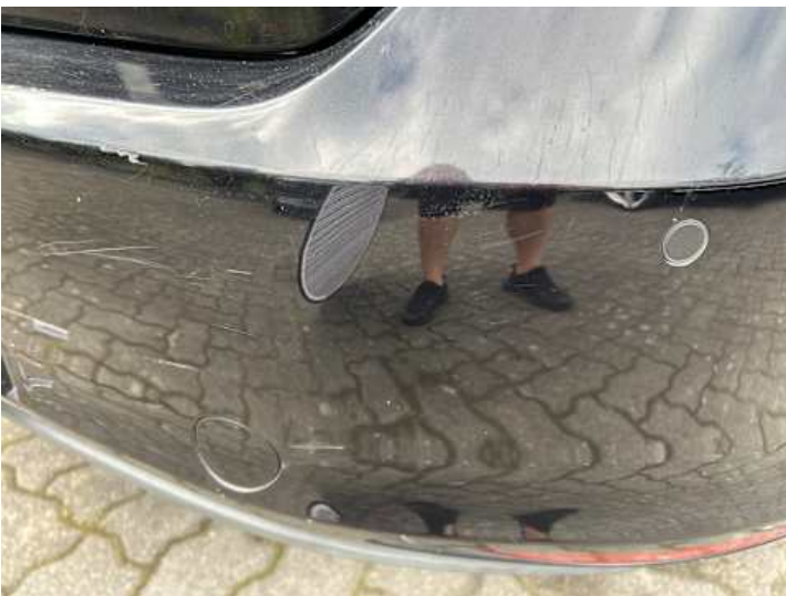
Stoßstange hinten (Kratzer, Lackschaden, Verformung)
