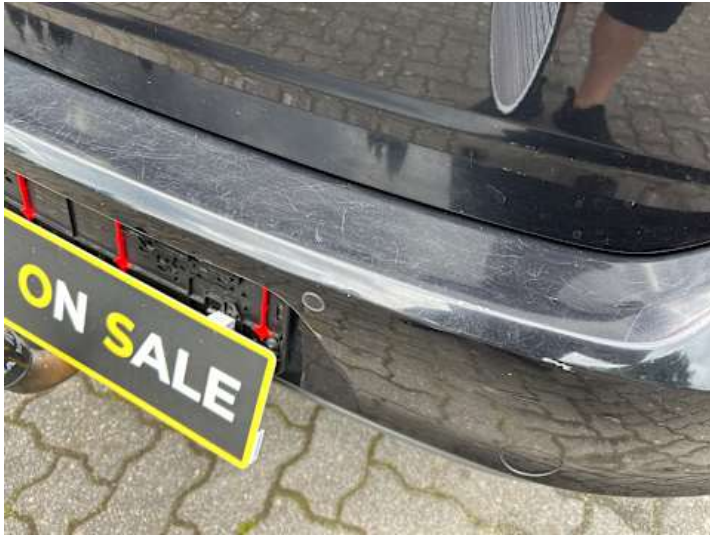
Stoßstange hinten (Kratzer, Lackschaden, Verformung)
