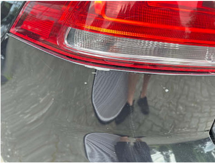
Stoßstange hinten (Kratzer, Lackschaden, Verformung)
