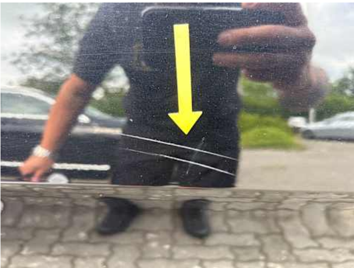
Türe hinten rechts (Lackschaden, Kratzer)
