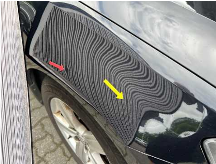
Kotflügel vorne rechts (Delle, Kratzer)
