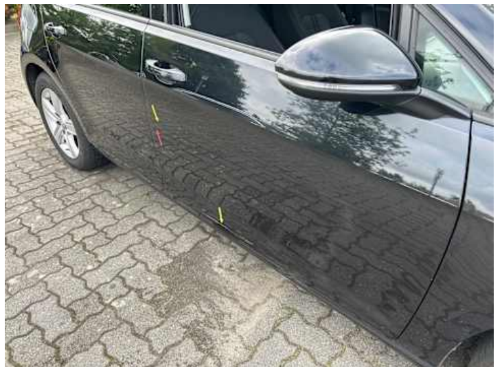
Beifahrtür (Kratzer, Lackschaden, Delle, Verformung)
