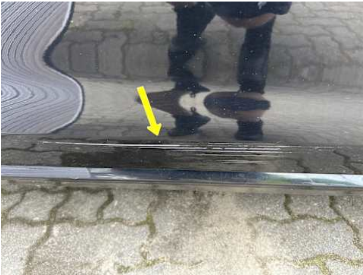
Beifahrertür (Kratzer, Lackschaden, Delle, Verformung)
