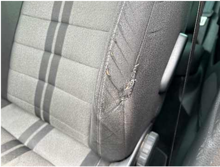
Innenraum (Riss/Bruch, Kratzer, Verschleiß, Tierhaare/Tiergeruch)
