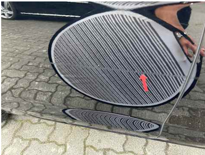
Türe hinten rechts (Lackschaden, Kratzer)
