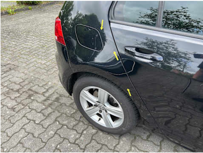
Seitenteil hinten rechts (Kratzer, Lackschaden)
