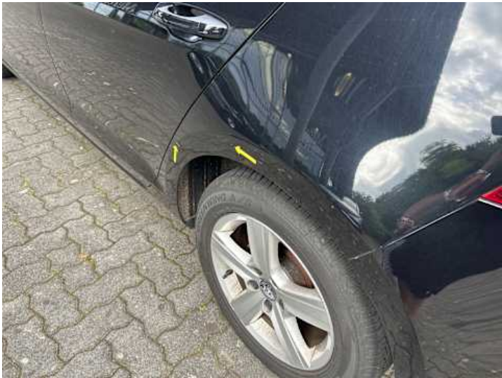
Seitenteil hinten links (Kratzer, Delle)
