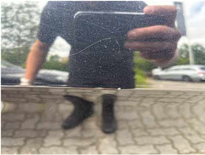
Beifahrertür (Kratzer, Lackschaden, Delle, Verformung)
