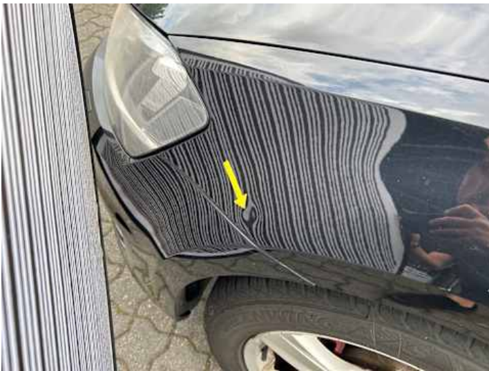
Kotflügel vorne links (Delle, Kratzer)
