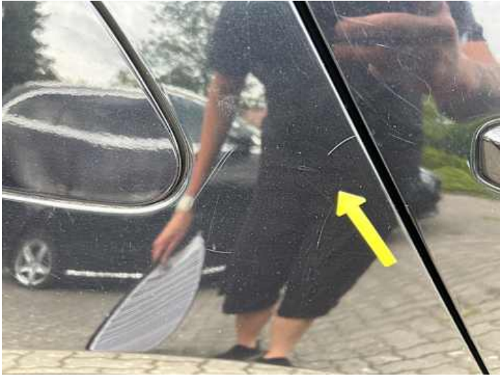
Seitenteil hinten rechts (Kratzer, Lackschaden)
