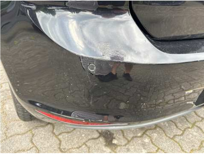
Stoßstange hinten (Kratzer, Lackschaden, Verformung)
