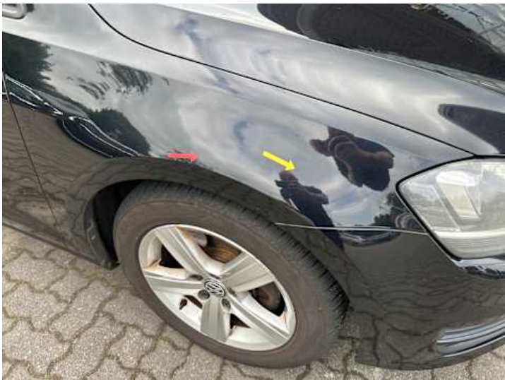
Kotflügel vorne rechts (Delle, Kratzer)
