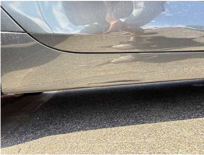
Schweller rechts (Riss/Bruch, Kratzer, Verformung)
