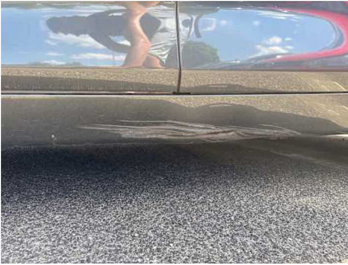
Schweller links (Verformung, Kratzer)
