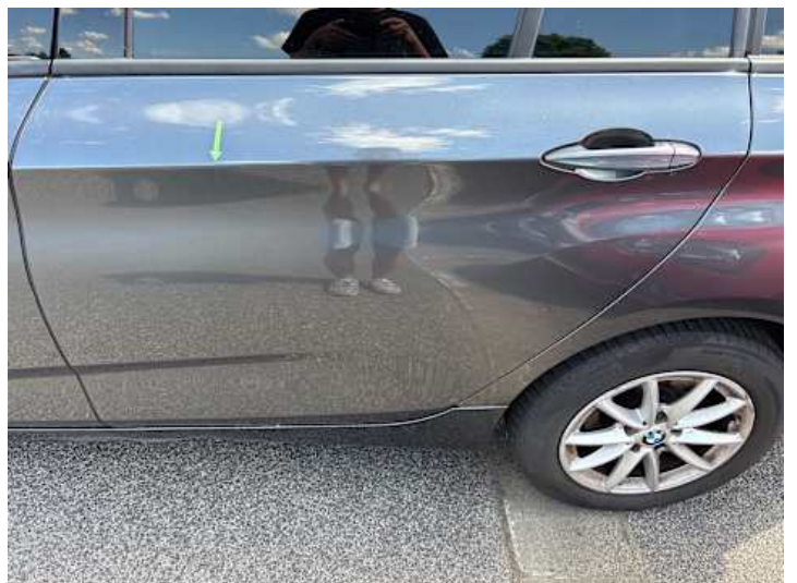
Türe hinten links (Kratzer)
