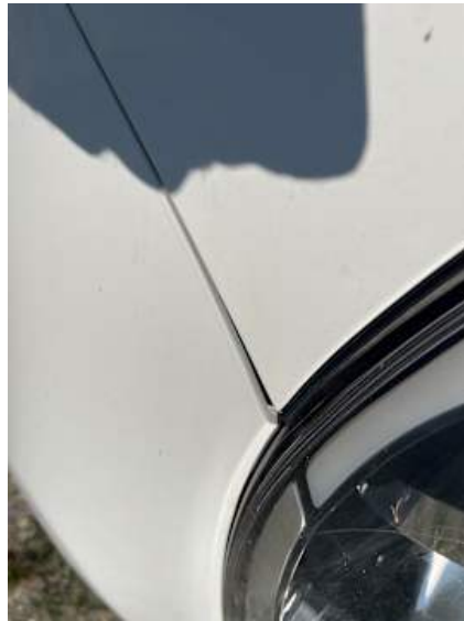
Stoßstange vorne (Spaltmaße ungenau)
