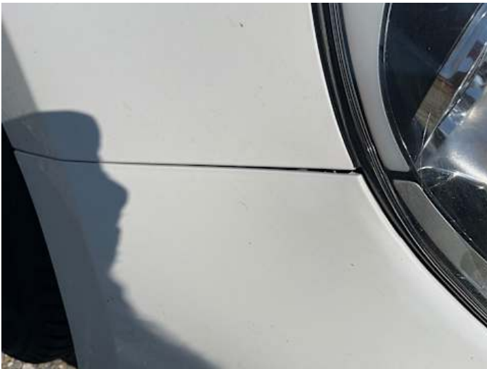
Stoßstange vorne (Spaltmaße ungenau)
