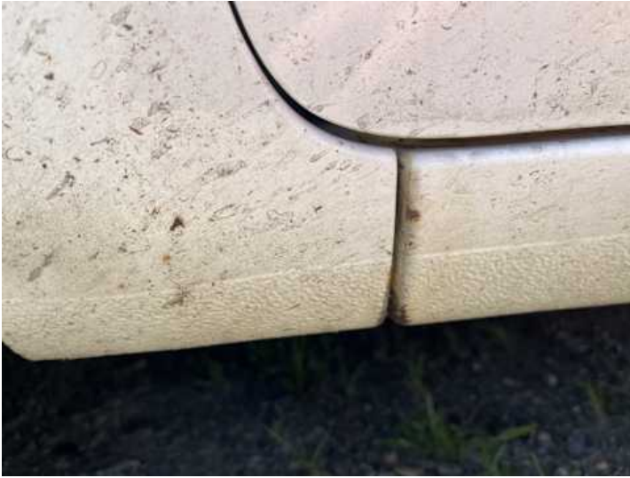
Schweller links (Rost)
