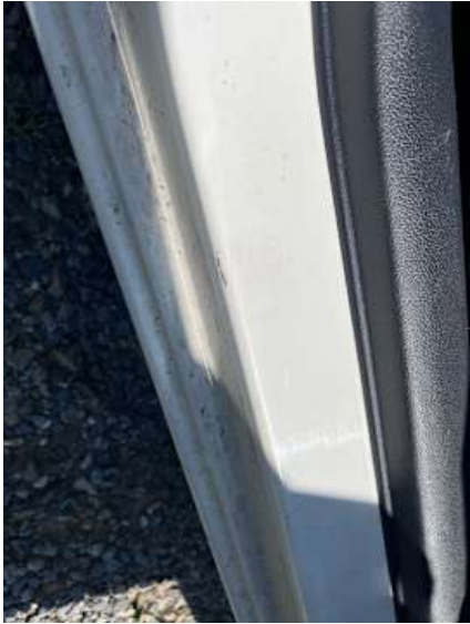
Schweller rechts (Kratzer)
