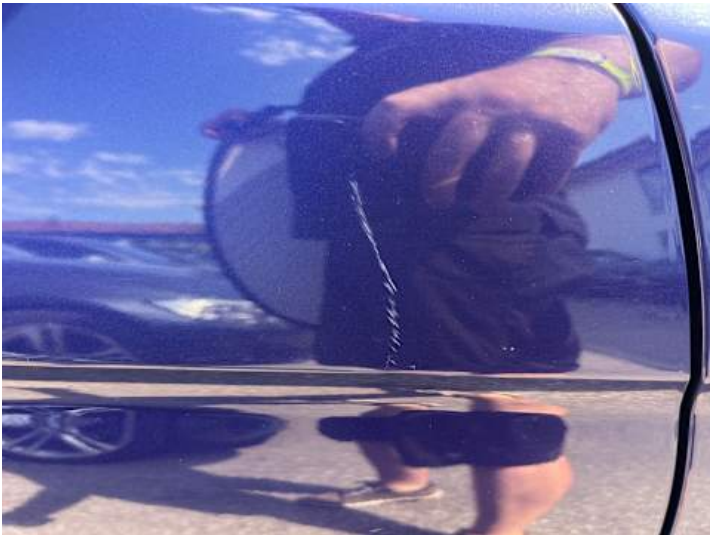
Beifahrertür (Kratzer, Lackschaden)
