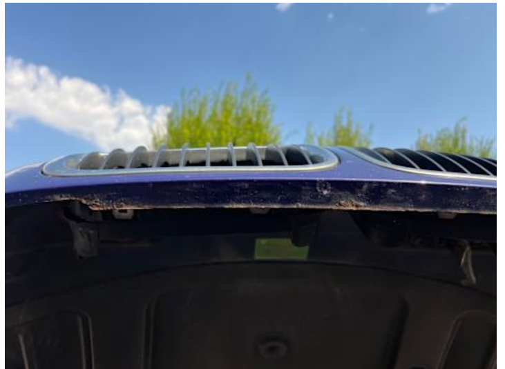
Motorhaube (Rost, Lackschaden)
