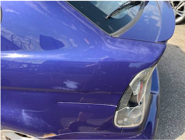
Seitenteil hinten links (Rost, Lackschaden, Ausgeblichen/Matt)
