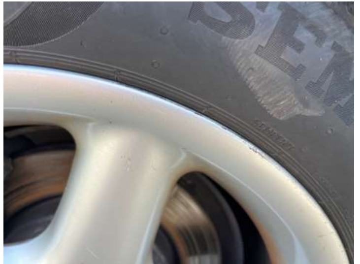
Rad (Kerben, Rost)
