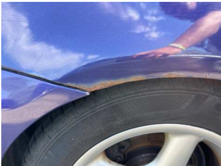
Seitenteil hinten rechts (Lackschaden, Rost, Unsachgemäß instand gesetzt)
