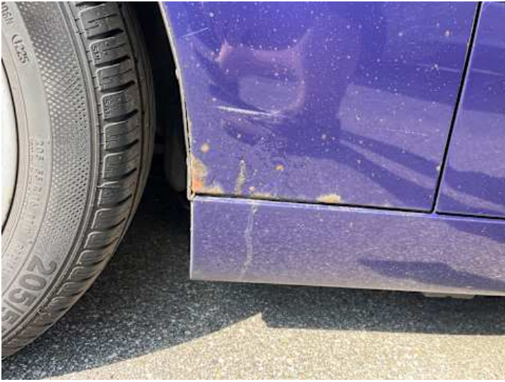
Kotflügel vorne links (Lackschaden, Rost, Verformung)
