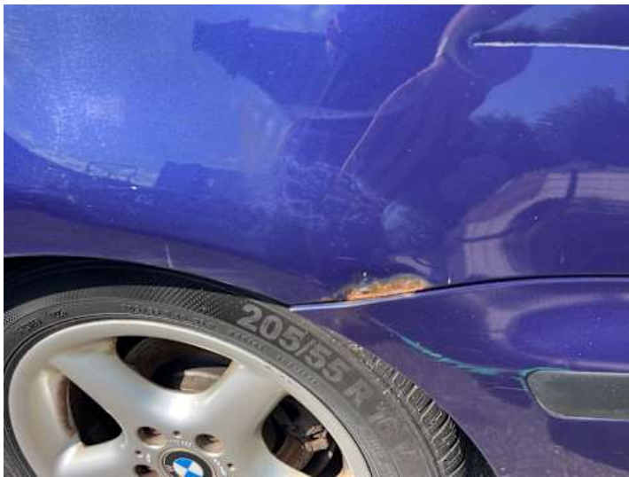
Seitenteil hinten links (Rost, Lackschaden, Ausgeblichen/Matt)
