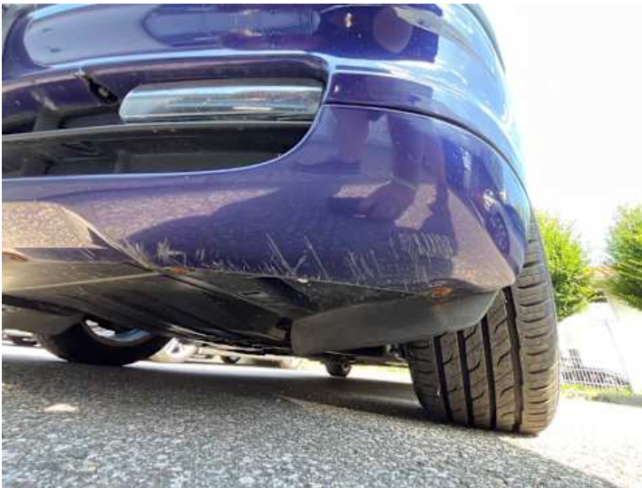
Stoßstange vorne (Kratzer, Lackschaden)
