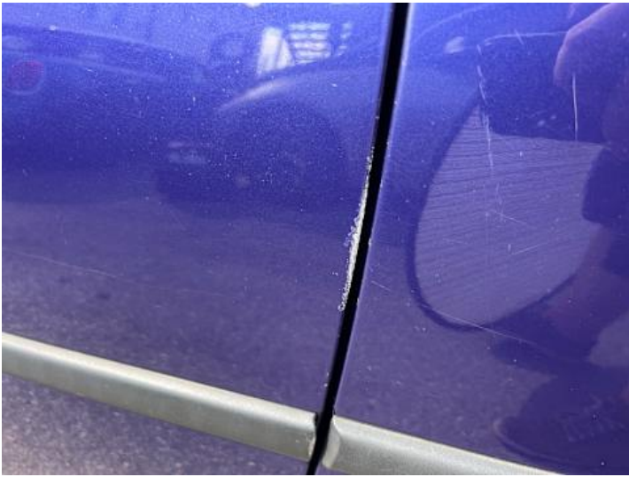
Fahrertür (Kratzer, Lackschaden)
