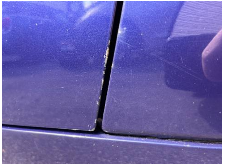
Fahrtür (Kratzer, Lackschaden)
