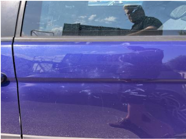
Seitenteil hinten links (Rost, Lackschaden, Ausgeblichen/Matt)
