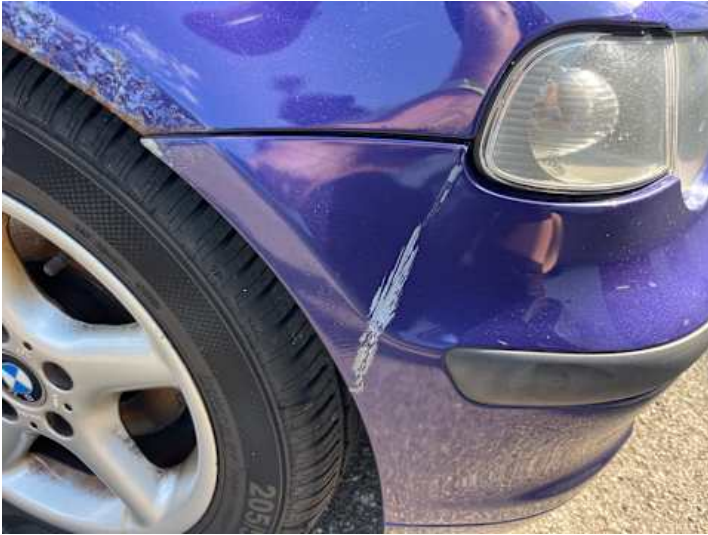
Stoßstange vorne (Kratzer, Lackschaden)
