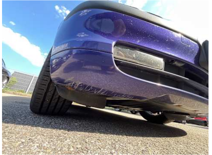
Stoßstange vorne (Kratzer, Lackschaden)
