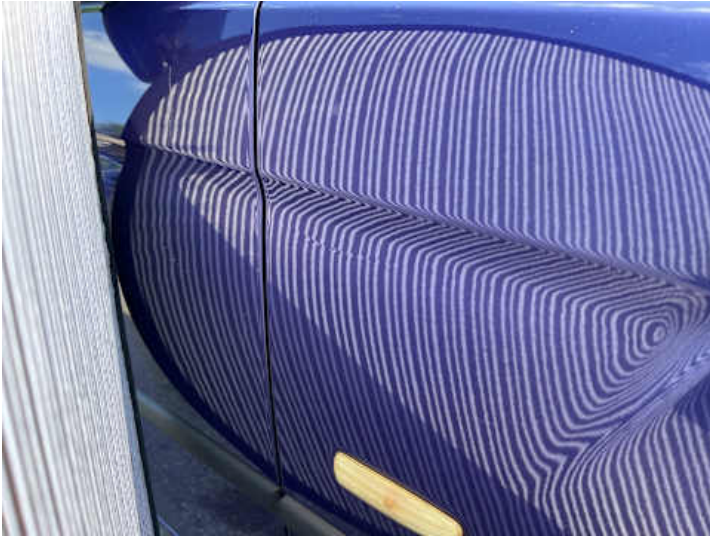
Kotflügel vorne rechts (Lackschaden, Unsachgemäß instand gesetzt)
