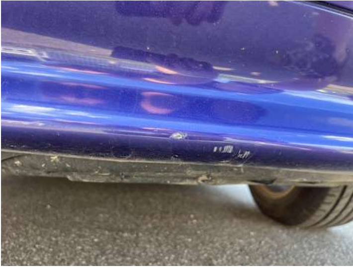
Stoßstange hinten (Kratzer, Lackschaden)
