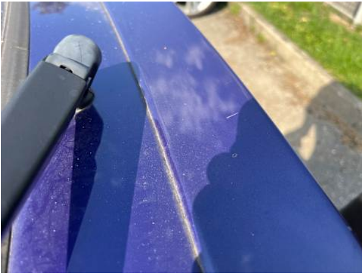
Heckklappe (Kratzer, Lackschaden)
