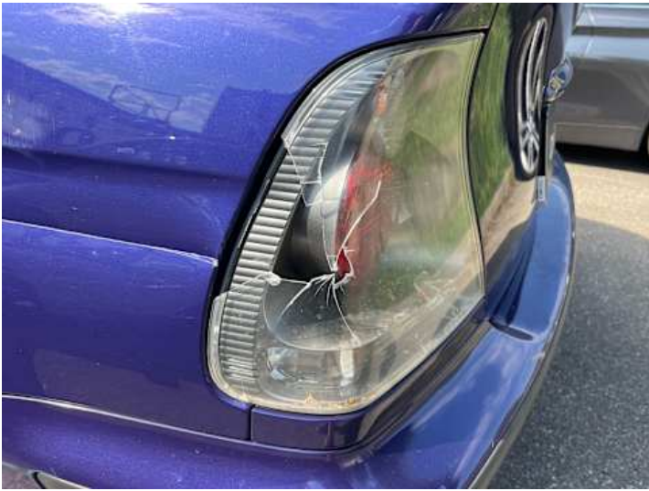
Rücklicht (links) (Riss/Bruch)
