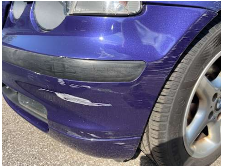
Stoßstange vorne (Kratzer, Lackschaden)
