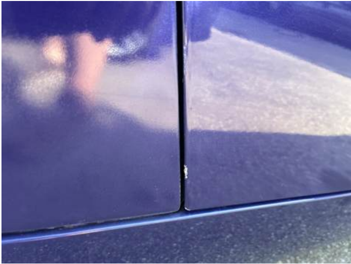
Beifahrertür (Kratzer, Lackschaden)
