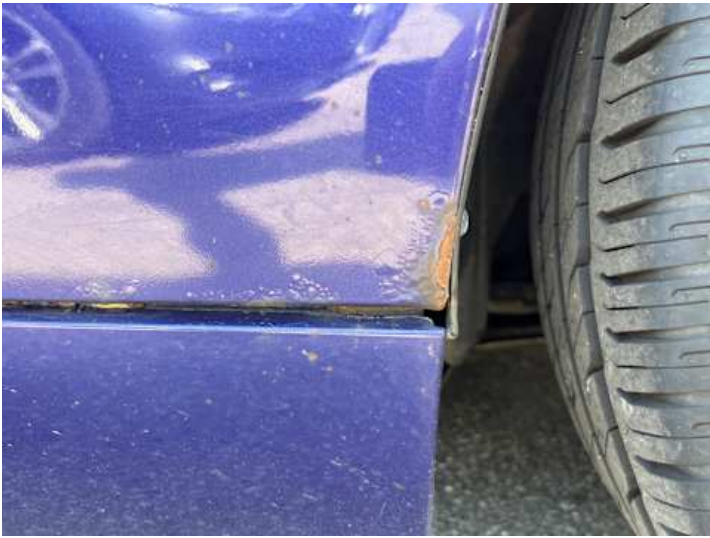
Kotflügel vorne rechts (Lackschaden, Rost)
