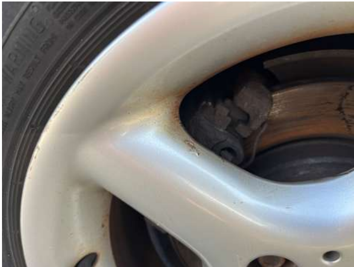
Rad (Kerben, Rost)
