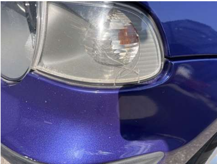
Scheinwerfer (links) (Riss/Bruch)
