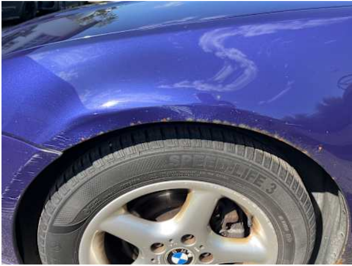
Kotflügel vorne links (Lackschaden, Rost, Verformung)
