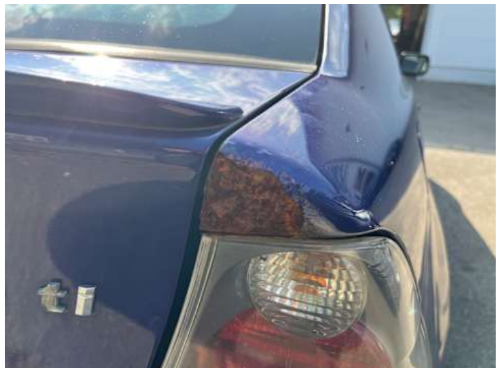
Seitenteil hinten rechts (Rost, Lackschaden)
