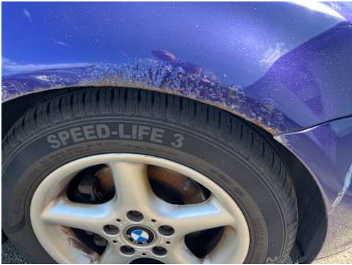
Kotflügel vorne rechts (Lackschaden, Rost)
