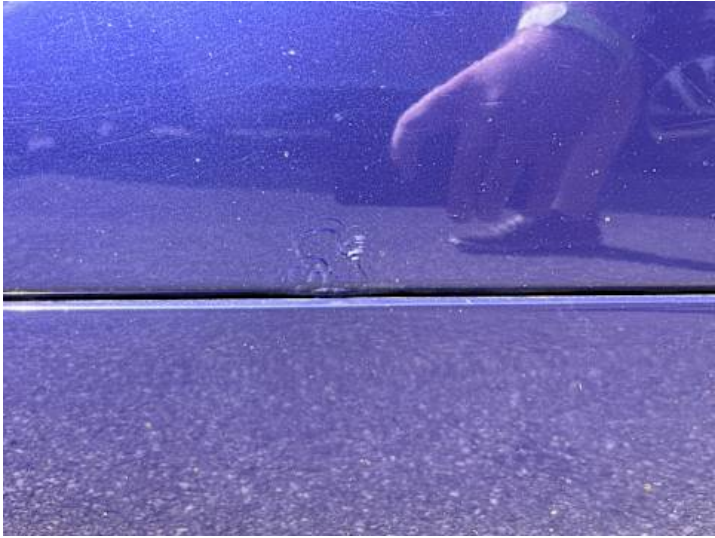
Seitenteil hinten links (Rost, Lackschaden, Ausgeblichen/Matt)
