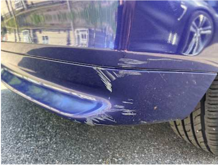
Stoßstange hinten (Kratzer, Lackschaden)
