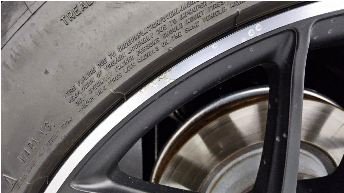
Bild 11 : Alufelge Glanzgedreht hinten rechts Kratzer, Minderwert
