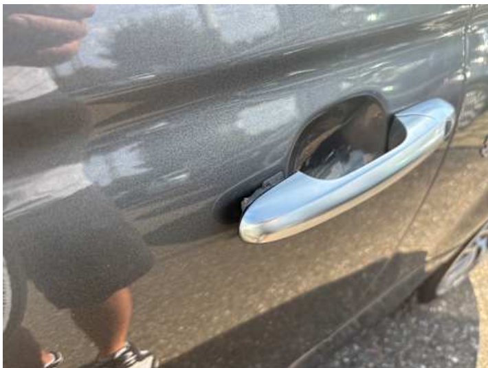
Fahrtür (Spaltmaße ungenau)
