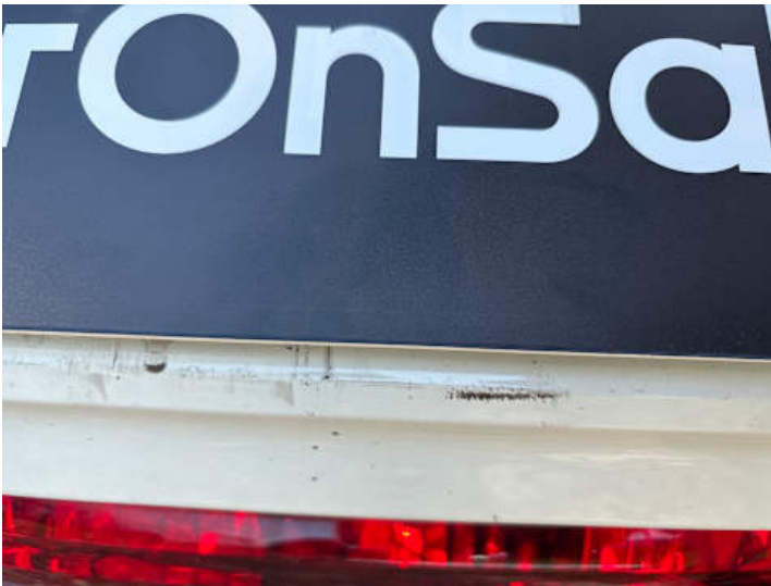
Stoßstange hinten (Kratzer)
