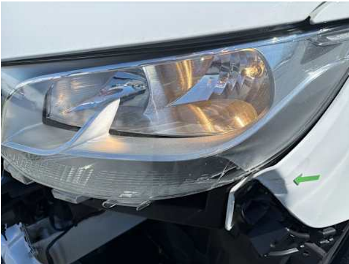
Scheinwerfer (links) (Riss/Bruch)
