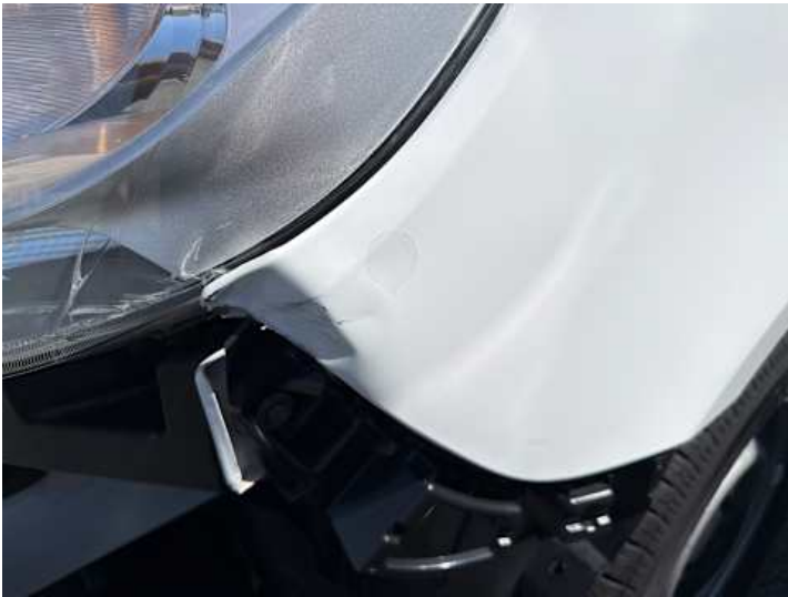
Kotflügel vorne links (Verformung, Kratzer)
