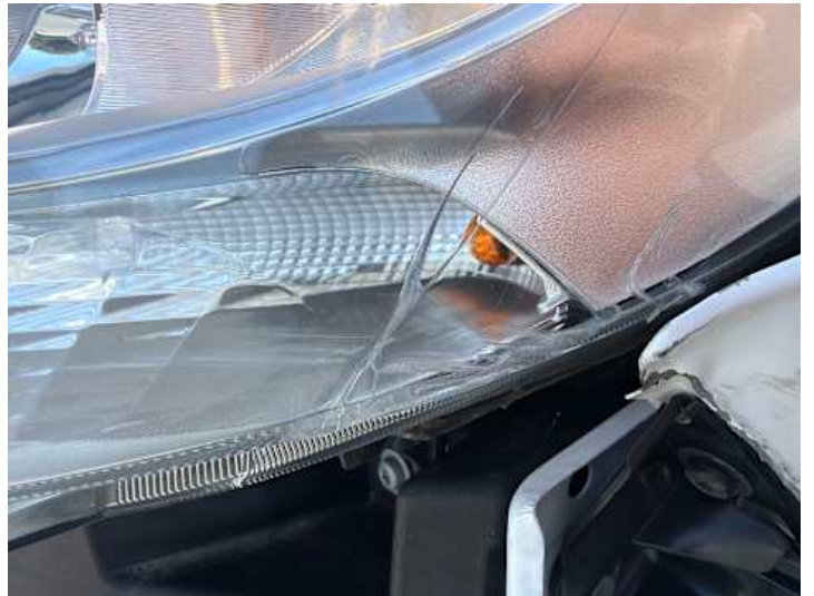
Scheinwerfer (links) (Riss/Bruch)
