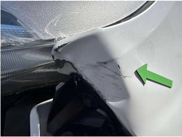
Kotflügel vorne links (Verformung, Kratzer)
