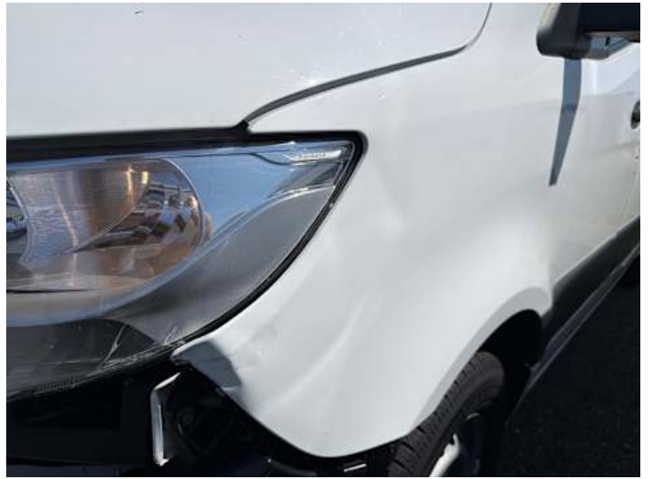
Kotflügel vorne links (Verformung, Kratzer)
