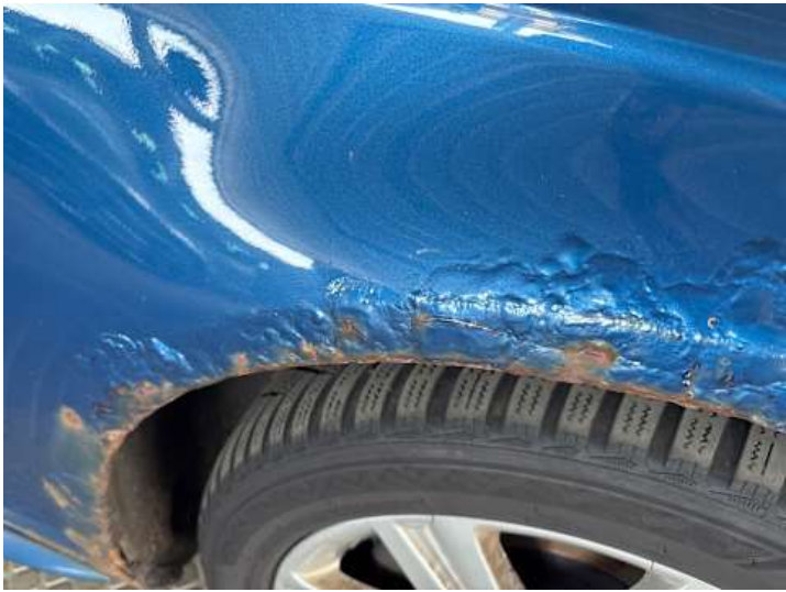
Kotflügel vorne rechts (Lackschaden, Rost)
