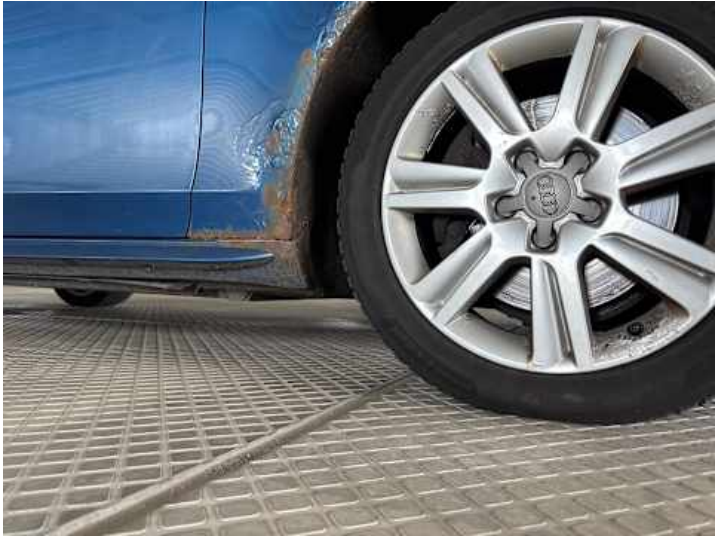
Schweller rechts (Rost)
