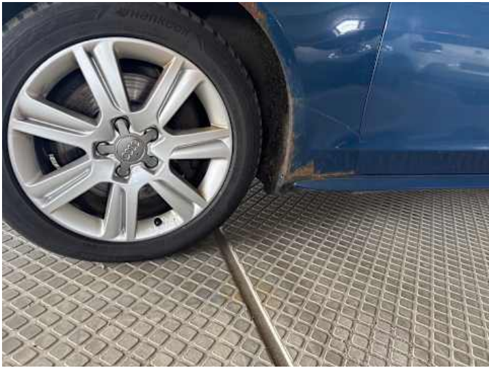
Schweller links (Rost)
