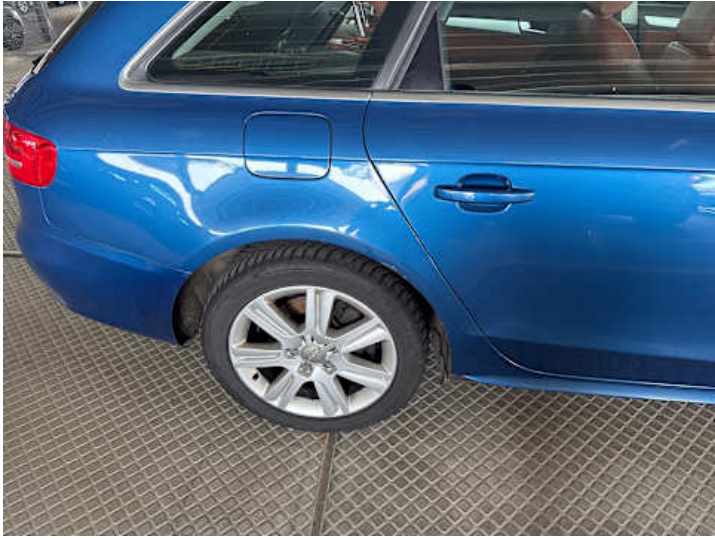
Seitenteil hinten rechts (Lackschaden, Rost)
