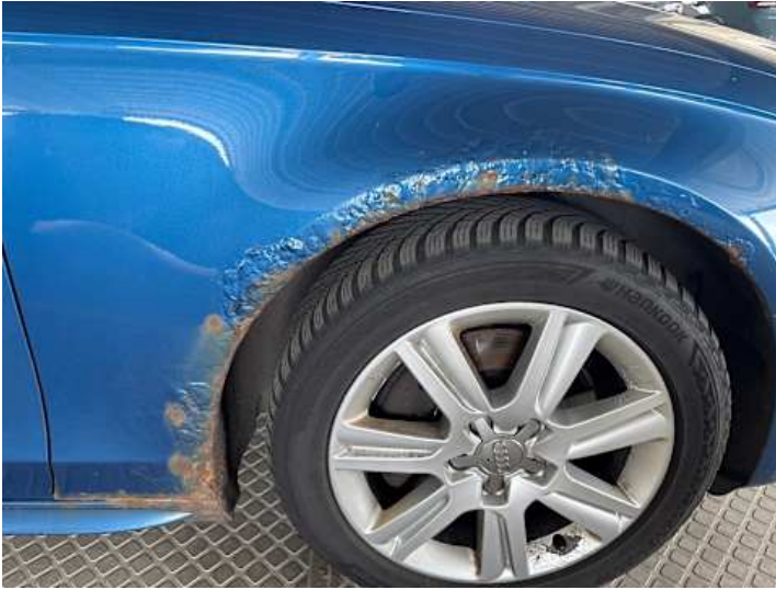
Kotflügel vorne rechts (Lackschaden, Rost)
