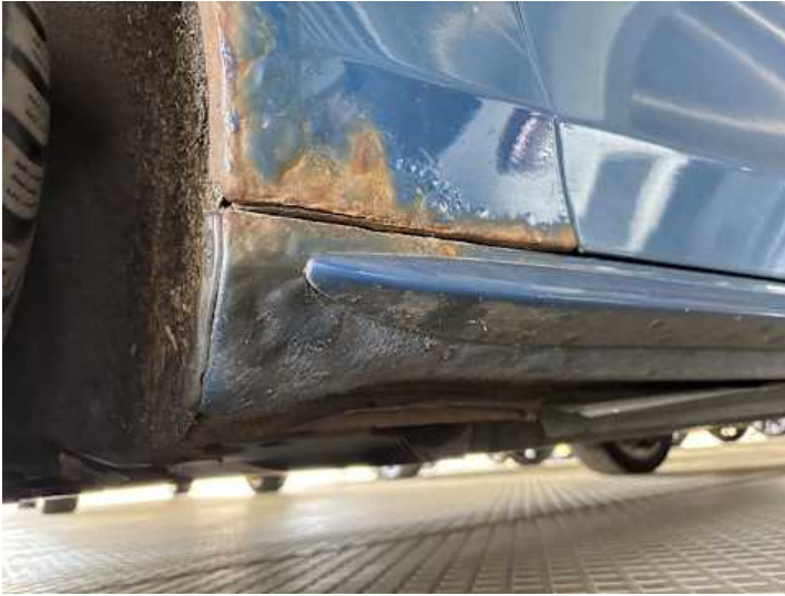
Schweller links (Rost)
