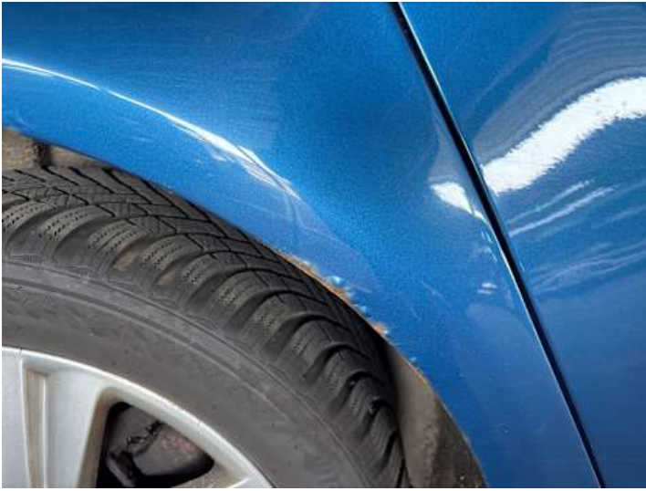
Seitenteil hinten rechts (Lackschaden, Rost)
