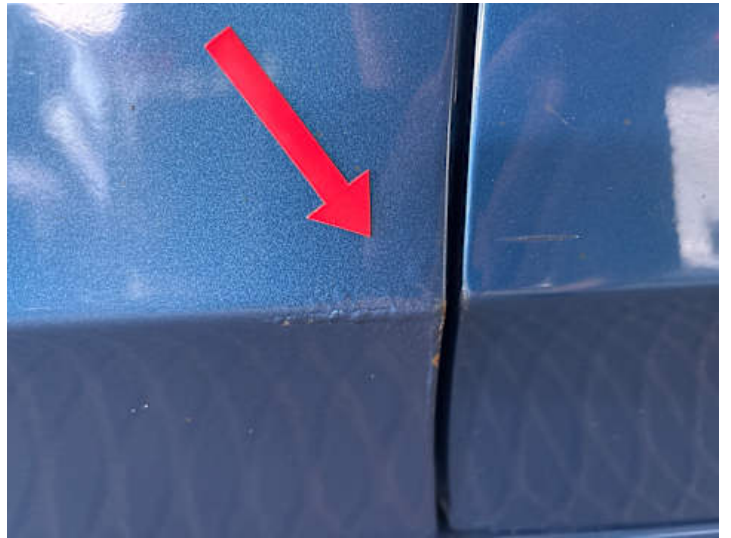
Fahrtür (Lackschaden, Rost)
