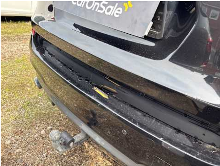
Stoßstange hinten (Verformung)
