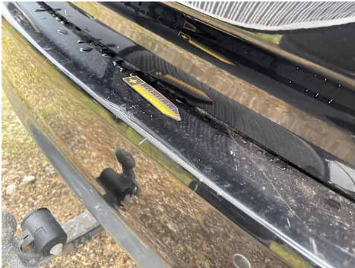
Stoßstange hinten (Verformung)
