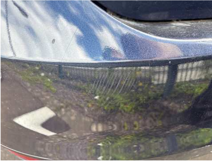
Stoßstange hinten (Kratzer, Lackschaden, Verformung)
