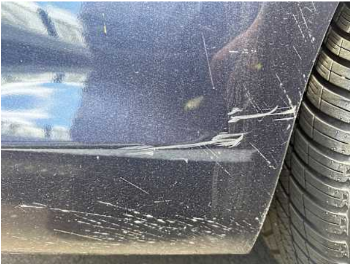
Stoßstange hinten (Kratzer, Lackschaden, Verformung)
