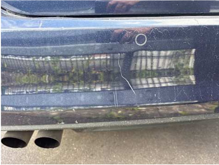
Stoßstange hinten (Kratzer, Lackschaden, Verformung)
