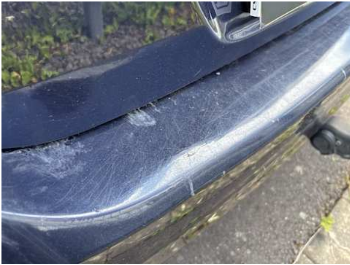
Stoßstange hinten (Kratzer, Lackschaden, Verformung)
