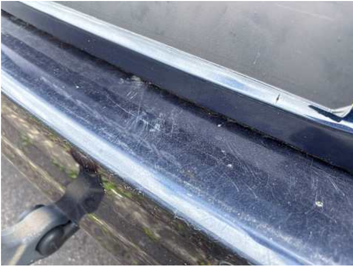
Stoßstange hinten (Kratzer, Lackschaden, Verformung)
