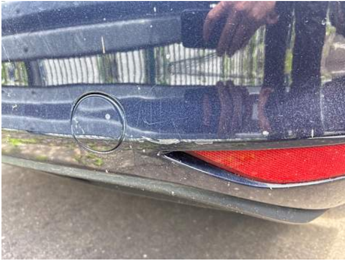
Stoßstange hinten (Kratzer, Lackschaden, Verformung)
