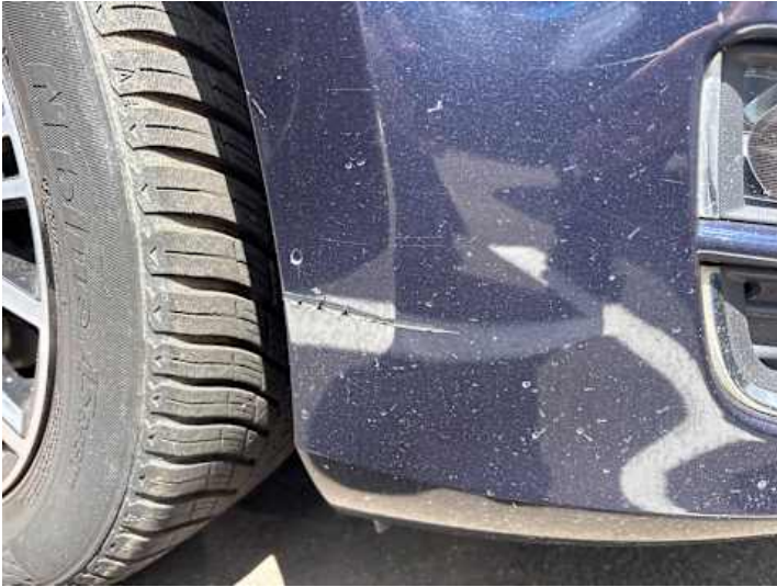
Stoßstange vorne (Kratzer)
