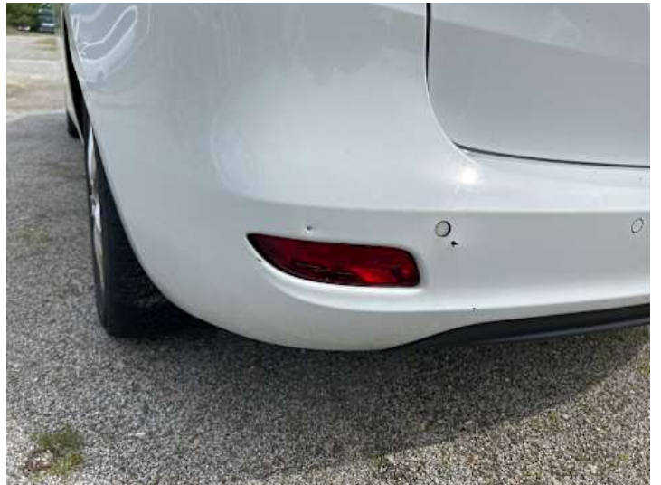
Stoßstange hinten (Kratzer, Verformung)
