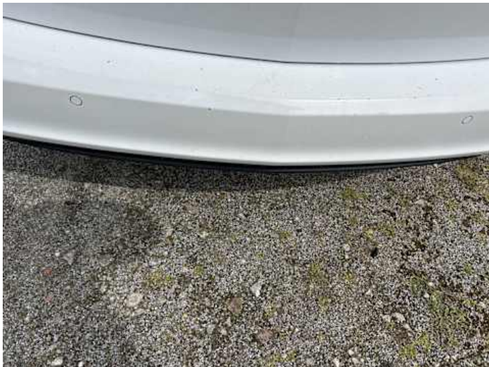
Stoßstange hinten (Kratzer, Verformung)
