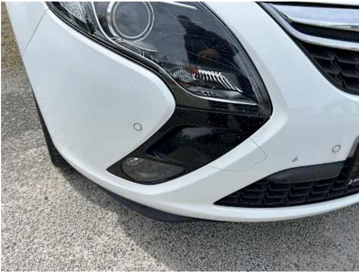
Stoßstange vorne (Steinschlag, Verformung, Kratzer)
