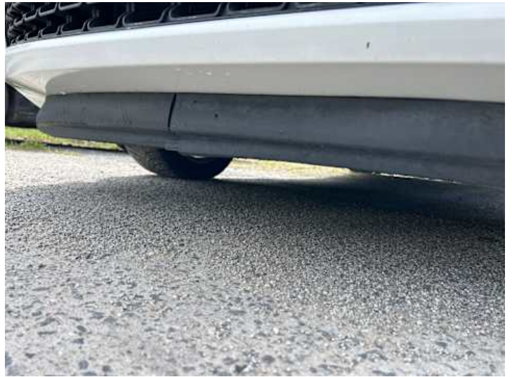
Stoßstange vorne (Steinschlag, Verformung, Kratzer)
