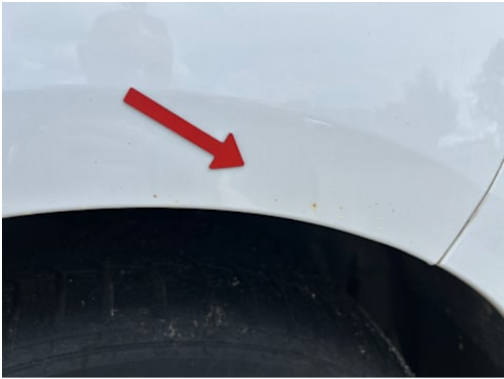
Seitenteil hinten links (Rost)
