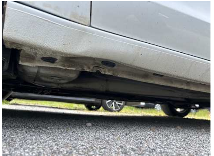
Schweller links (Verformung)
