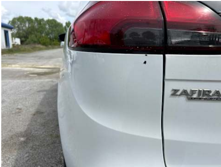
Stoßstange hinten (Kratzer, Verformung)
