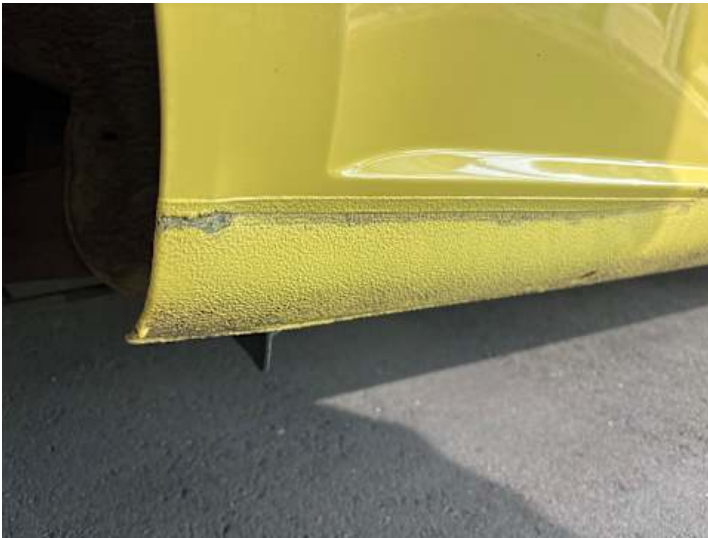
Schweller rechts (Lackschaden, Rost, Verformung)
