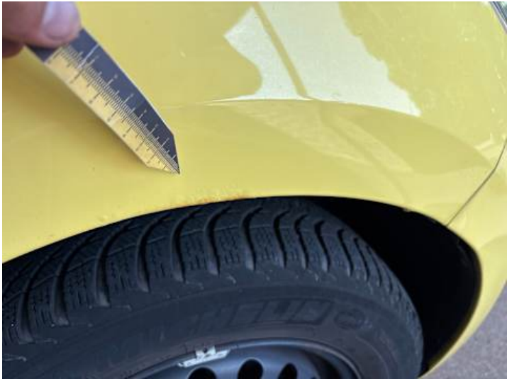
Kotflügel vorne rechts (Lackschaden, Rost)
