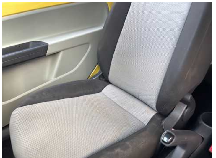
Innenraum (Verschleiß, Verschmutzung)
