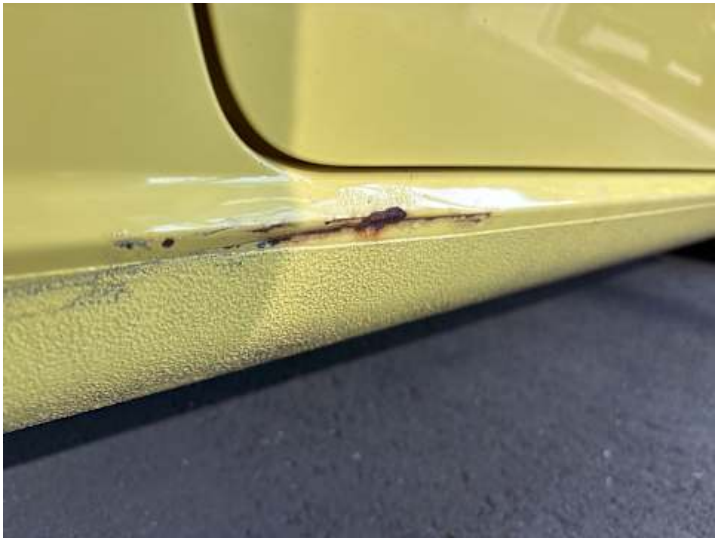
Schweller rechts (Lackschaden, Rost, Verformung)
