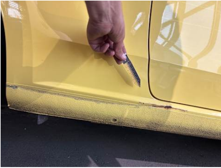
Schweller rechts (Lackschaden, Rost, Verformung)
