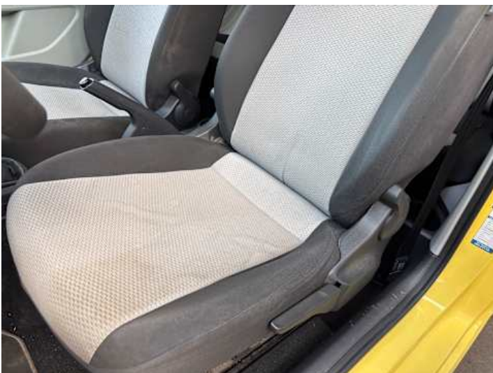
Innenraum (Verschleiß, Verschmutzung)
