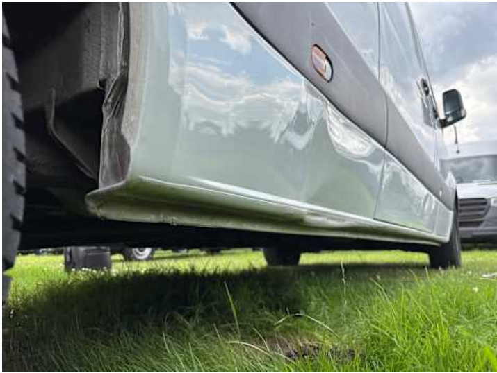
Schweller rechts (Verformung, Kratzer, Delle)
