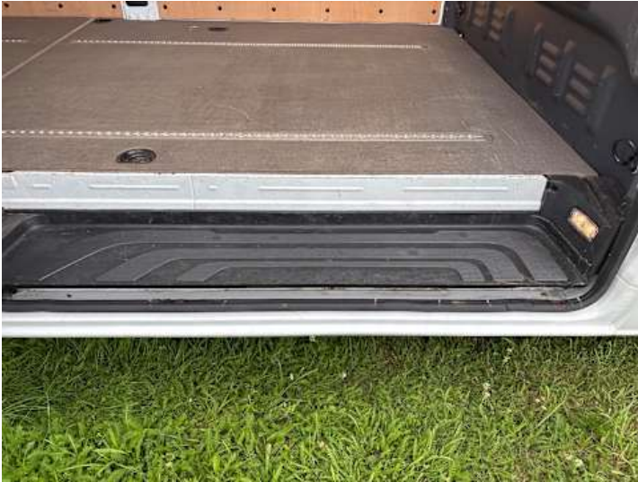
Schweller rechts (Rost, Riss/Bruch)
