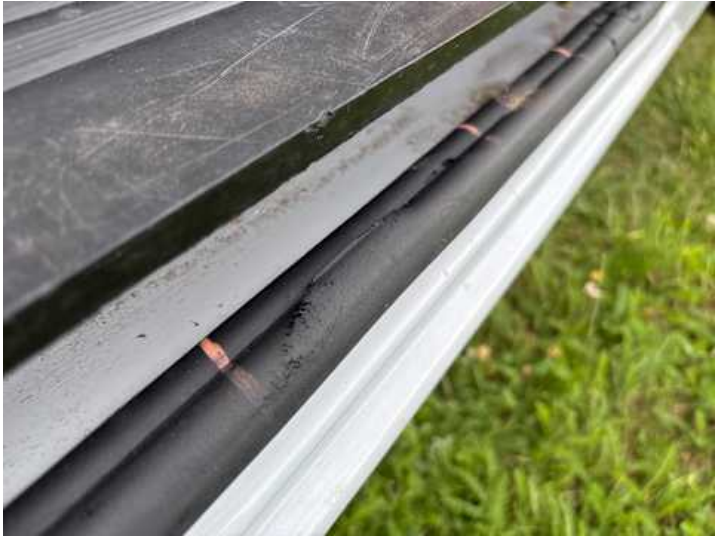
Schweller rechts (Rost, Riss/Bruch)
