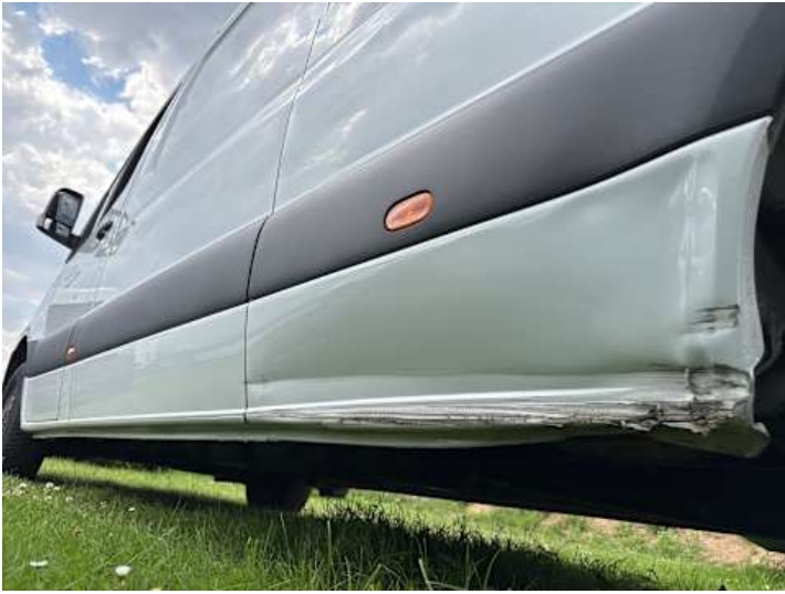
Schweller links (Verformung, Kratzer)
