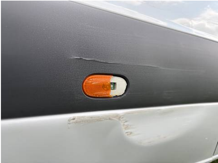
Seitenteil hinten rechts (Riss/Bruch)
