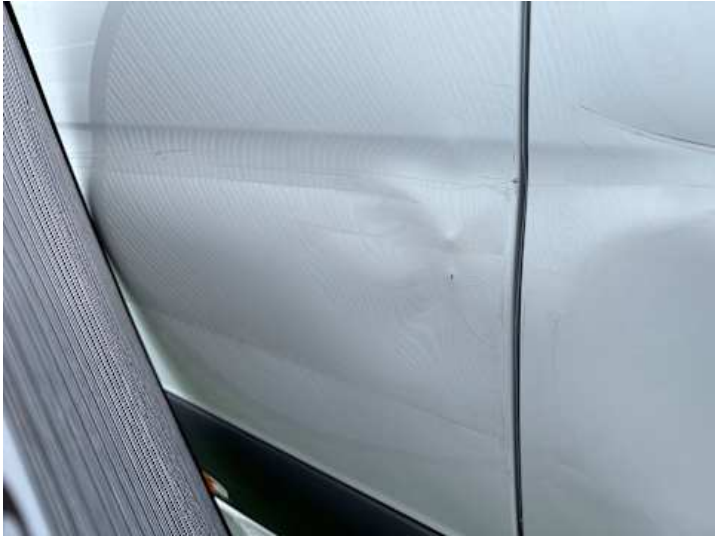
Seitenteil hinten rechts (Verformung, Kratzer, Delle)
