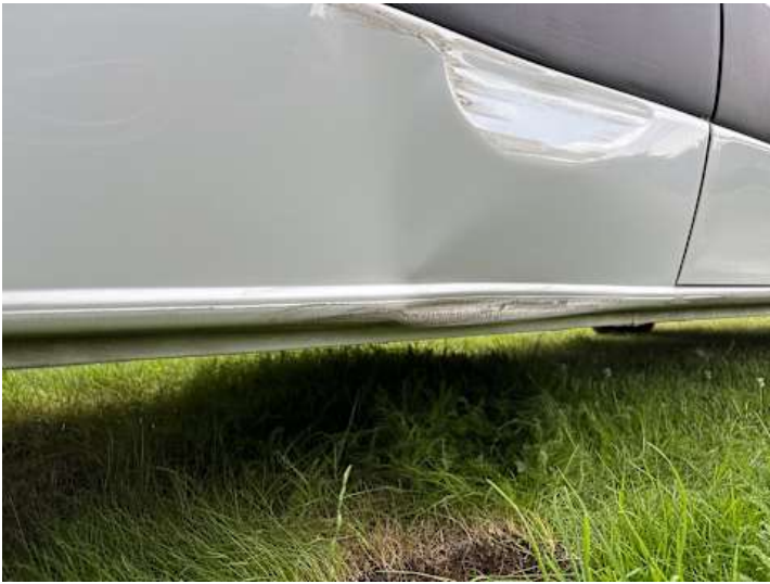
Schweller rechts (Verformung, Kratzer, Delle)
