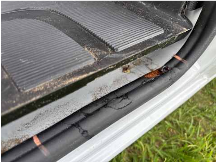
Schweller rechts (Rost, Riss/Bruch)
