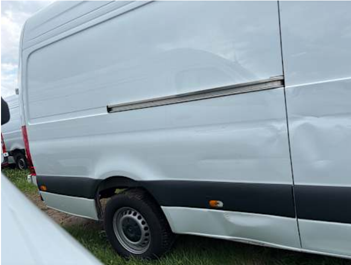
Seitenteil hinten rechts (Verformung, Kratzer, Delle)
