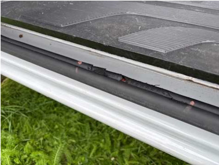
Schweller rechts (Rost, Riss/Bruch)
