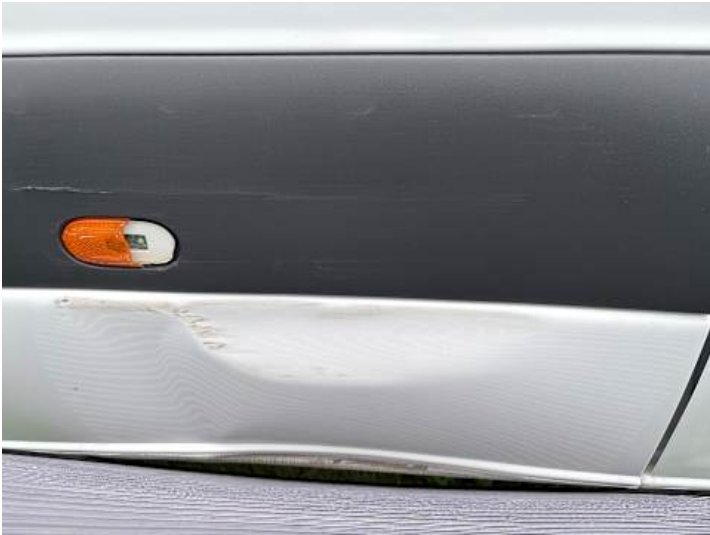
Seitenteil hinten rechts (Verformung, Kratzer, Delle)
