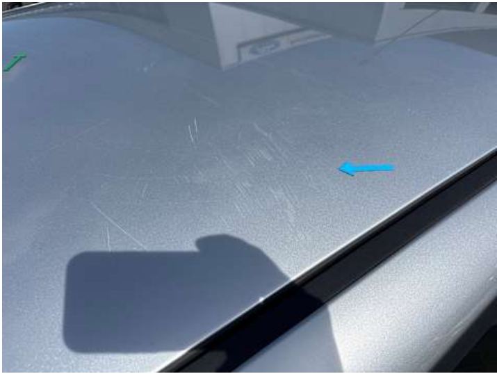
Dach (Delle, Kratzer)
