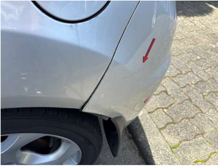
Stoßstange hinten (Unsachgemäß instand gesetzt, Spaltmaße ungenau)
