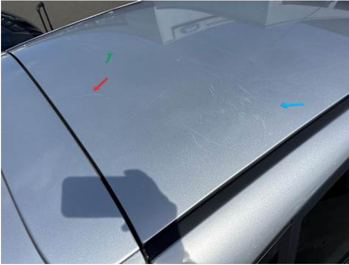
Dach (Delle, Kratzer)
