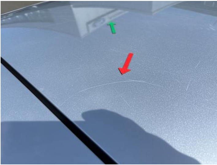
Dach (Delle, Kratzer)
