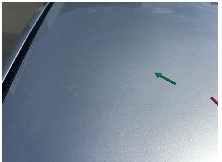
Dach (Delle, Kratzer)
