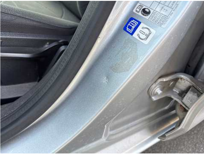
Schweller links (Delle, Lackschaden)
