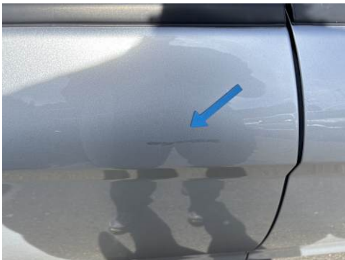
Türe hinten rechts (Unsachgemäß instand gesetzt)
