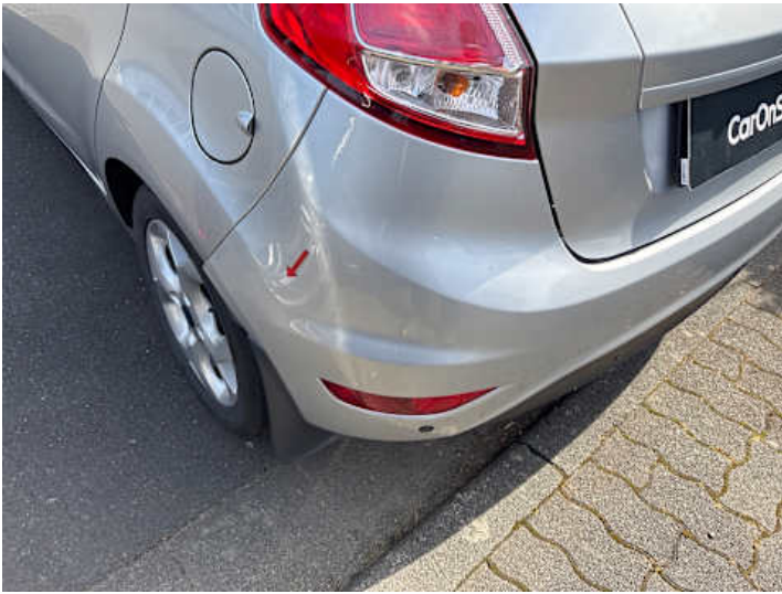
Stoßstange hinten (Unsachgemäß instand gesetzt, Spaltmaße ungenau)
