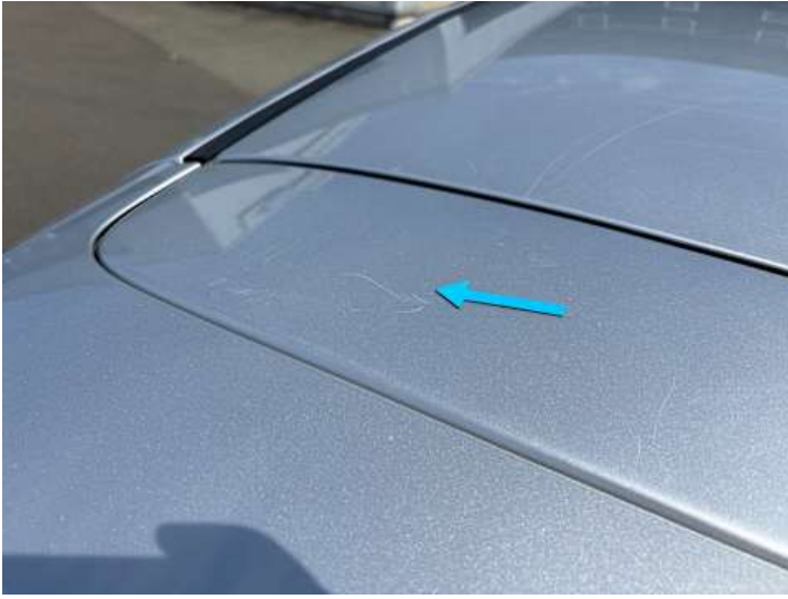
Heckklappe (Delle, Kratzer)
