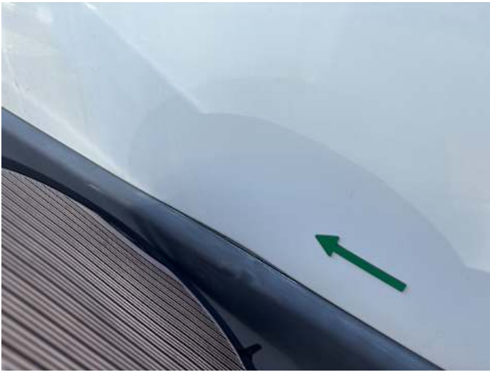
Seitenteil hinten links (Verformung)
