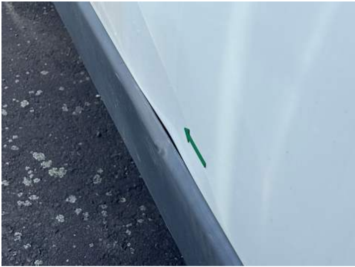
Seitenteil hinten links (Verformung)
