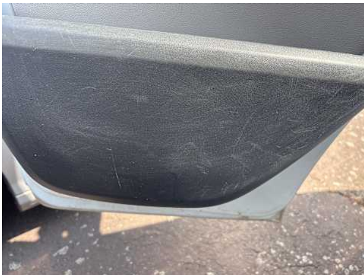
Innenraum (Verschleiß, Kratzer, Diverse Schäden)
